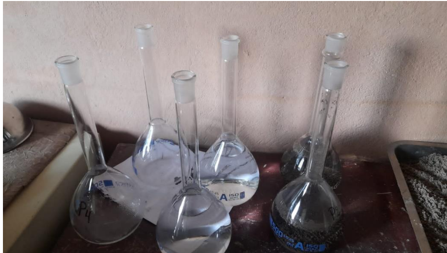
Ilustración 3-13: Medición de la masa del picnómetro con agua destilada
