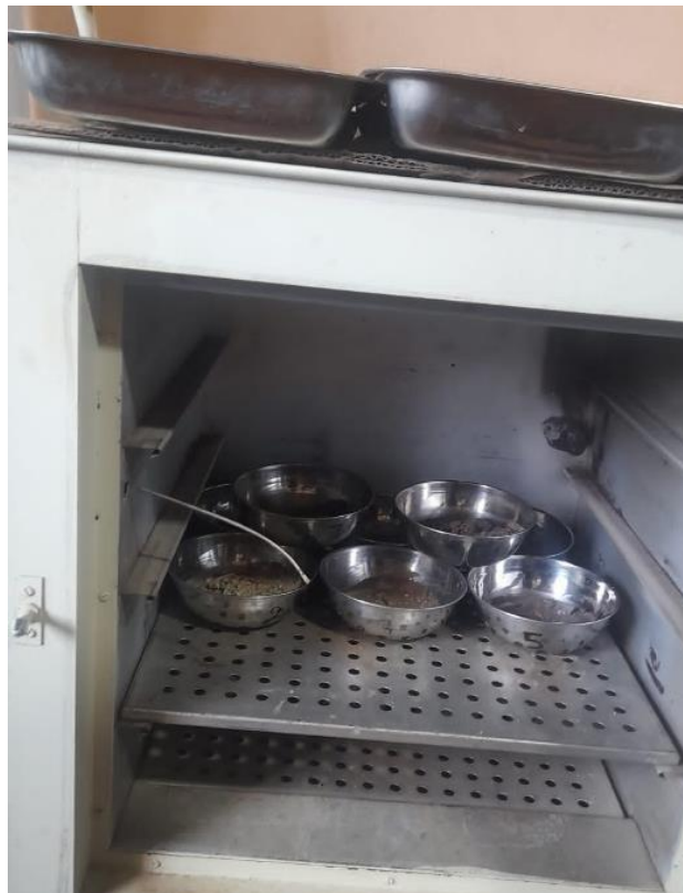
Ilustración 3-12: Muestra del picnómetro en el horno a 100 \pm 5 °C
