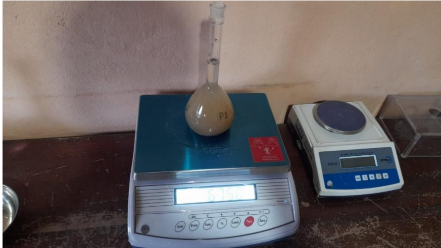
Ilustración 3-11: Medición de la masa del picnómetro con agua y muestra
