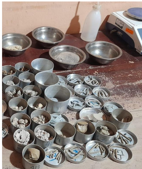
Ilustración 3-6: Cilindros de 3mm de diámetro
