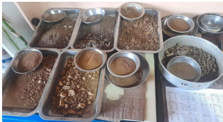
Ilustración 3-4: Fracción de muestra de la malla #40
