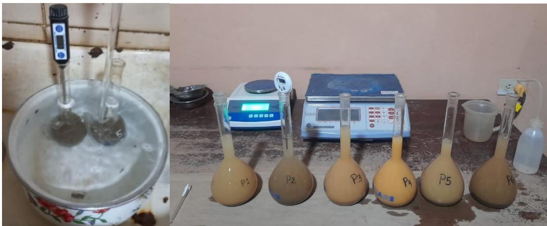
Ilustración 3-10: Inmersión de este en un baño de agua a 23 \pm 2 °C
