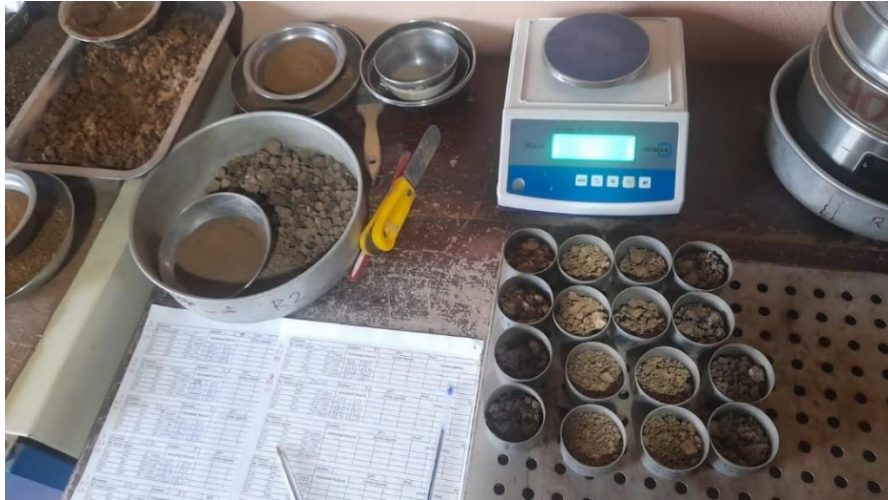
Ilustración 3-7: Medición del peso húmedo
