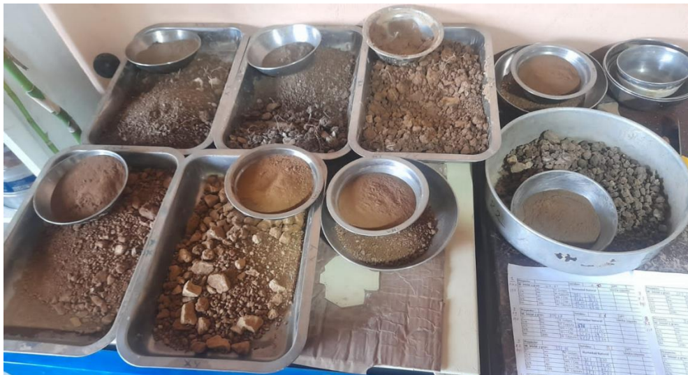
Ilustración 3-8: Medición del peso húmedo
