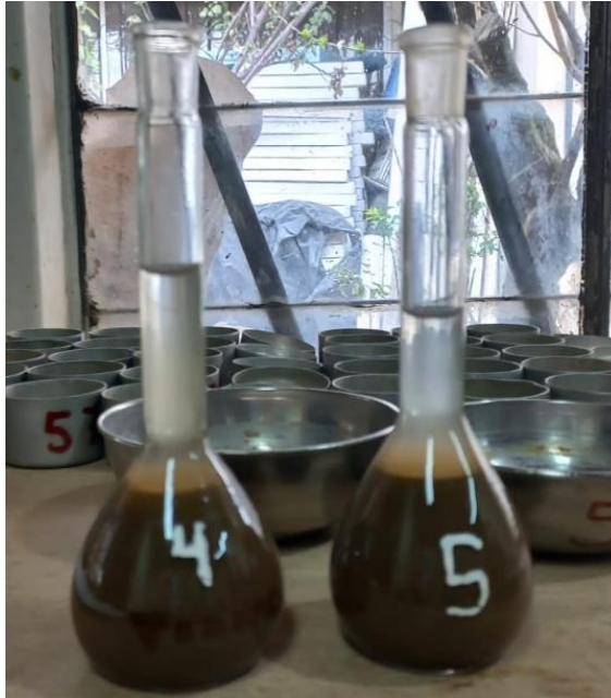
Ilustración 3-9: Eliminación de burbujas dentro del picnómetro
