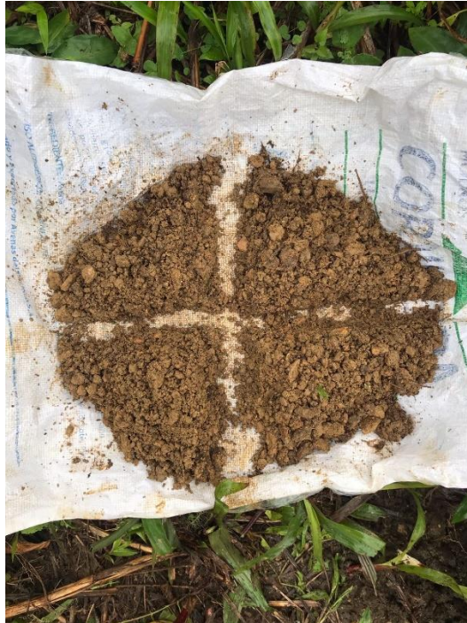
Ilustración 3-2: Cuarteo de la muestra
