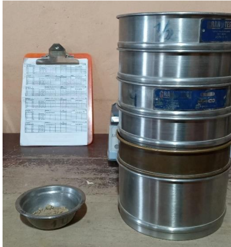
Ilustración 3-3: Tamizado de muestras
