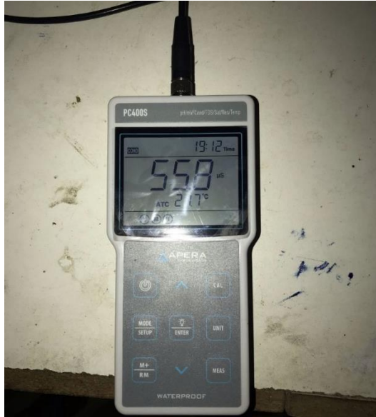
Ilustración 3-16: Medición de la conductividad eléctrica
