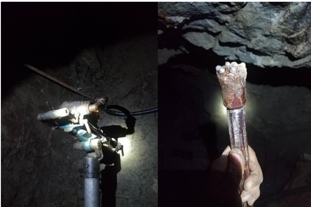
Ilustración 3-4: Perforadora manual, barreno y broca
