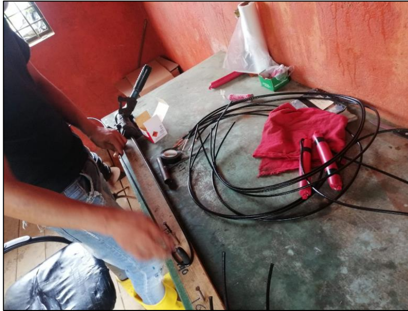
Ilustración 3-3: Preparación de la mecha con explosivo
