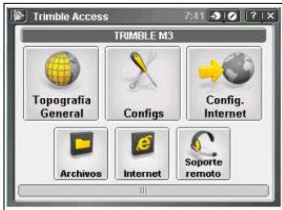
**Ilustración 16-3:** Pantalla principal de Trimble Access de la estación total Trimble C5.
