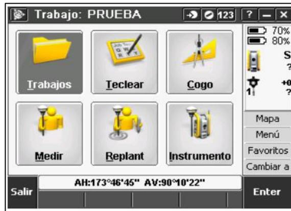
**Ilustración 17-3:** Menú de topografía general de Trimble Access de la estación total Trimble C5.
