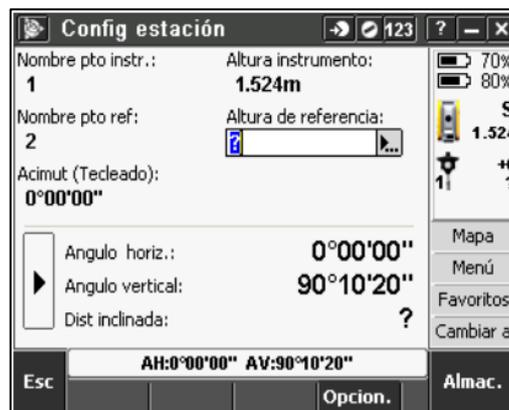
**Ilustración 22-3:** Visualización de puntos medidos en la estación total Trimble C5.
