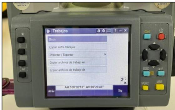
**Ilustración 29-3:** Selección para acceso al menú de importar/exportar de la aplicación Trimble Access.
