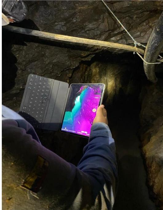
**Ilustración 33-3:** Levantamiento topográfico con sensor LiDAR
