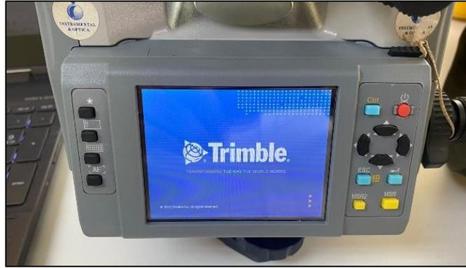
**Ilustración 14-3:** Encendido de la estación total Trimble C5.
