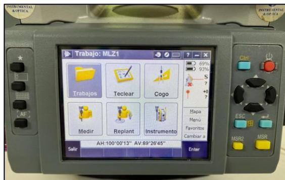
**Ilustración 27-3:** Pantalla principal de la aplicación Trimble Access.
