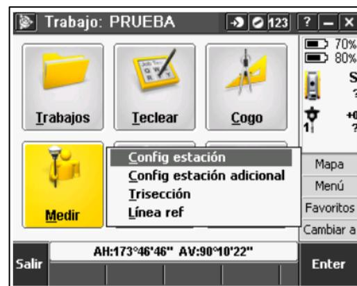
**Ilustración 20-3:** Menú de medir de la aplicación Trimble Access de la estación total Trimble C5.
