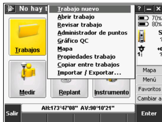
**Ilustración 18-3:** Menú de trabajos de aplicación Trimble Access de la estación total Trimble C5.
