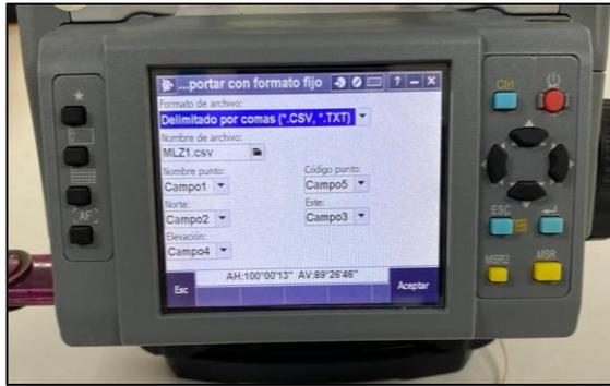
**Ilustración 30-3:** Pantalla de exportación de la aplicación Trimble Access.
