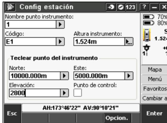
**Ilustración 21-3:** Ajuste de puntos de referencia para el levantamiento topográfico con estación total.
