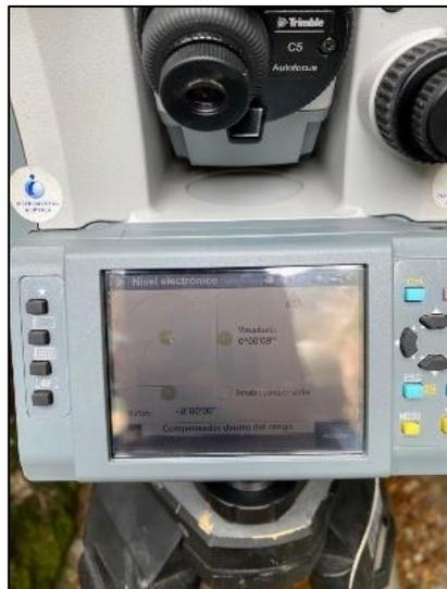
**Ilustración 12-3:** Ajuste de la nivelación electrónica.
