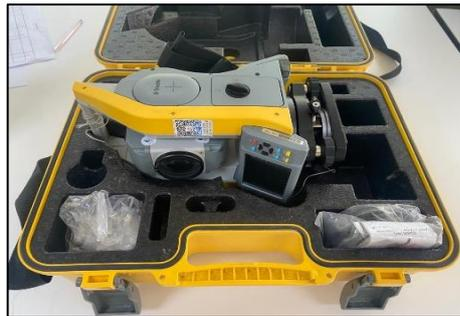
**Ilustración 9-3:** Instrumento necesario para el levantamiento topográfico con estación total.
