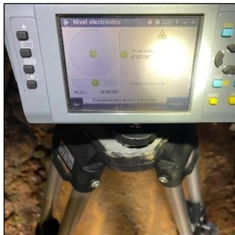
**Ilustración 11-3:** Anclaje de la estación total al trípode.
