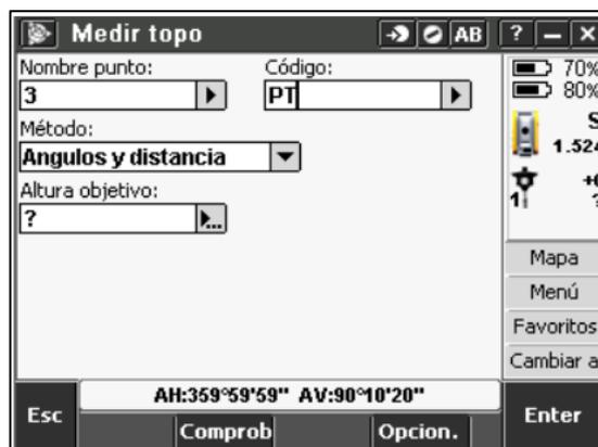
**Ilustración 24-3:** Visualización de puntos medidos en la estación total Trimble C5.
