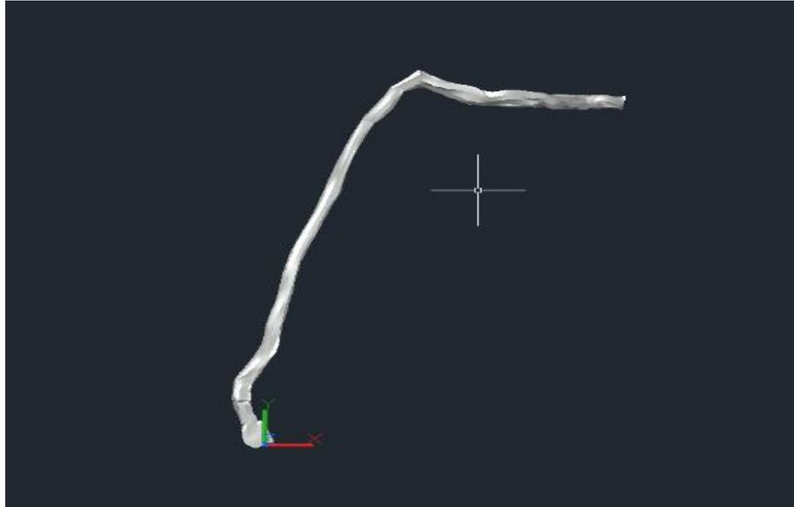
**Ilustración 53-4:** Visualización del modelado 3D en AutoCAD proveniente del levantamiento topográfico con estación total.
