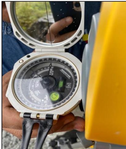
**Ilustración 13-3:** Orientación de la estación total al norte magnético.
