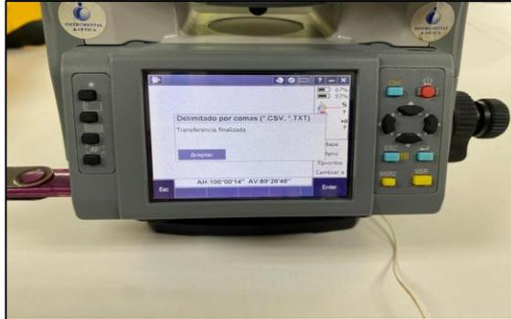
**Ilustración 32-3:** Verificación de la exportación de datos de la estación total.
