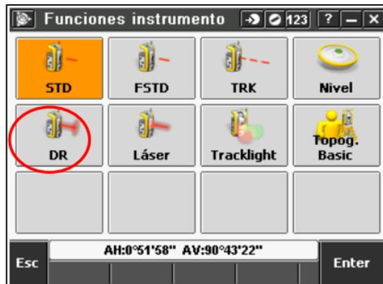
**Ilustración 25-3:** Activación de láser de la estación total Trimble C5.
