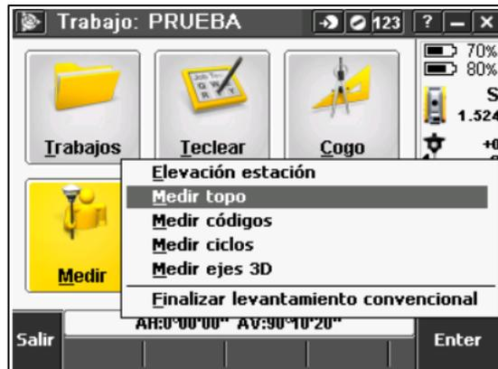
**Ilustración 23-3:** Menú medir de la aplicación Trimble Access de la estación total Trimble C5.
