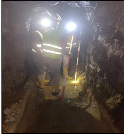
**Ilustración 7-3:** Ubicación de los jalones para el levantamiento topográfico con cinta y brújula.
