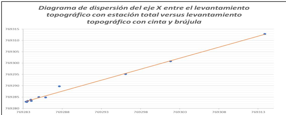
**Ilustración 75-5:** Diagrama de dispersión del eje X del levantamiento topográfico con cinta y brújula.
