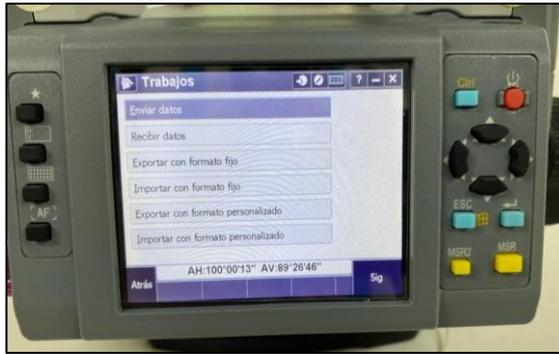
**Ilustración 28-3:** Menú de trabajos de la aplicación Trimble Access de la estación total Trimble C5.
