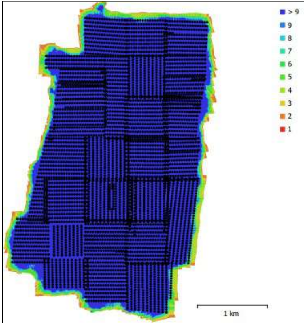
Ilustración 4-1: Posiciones de cámaras y solapamiento de imágenes
