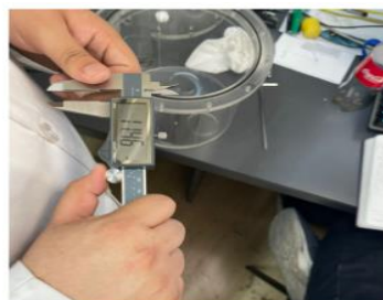
Mediciones del fantoma con un calibrador Vernier
