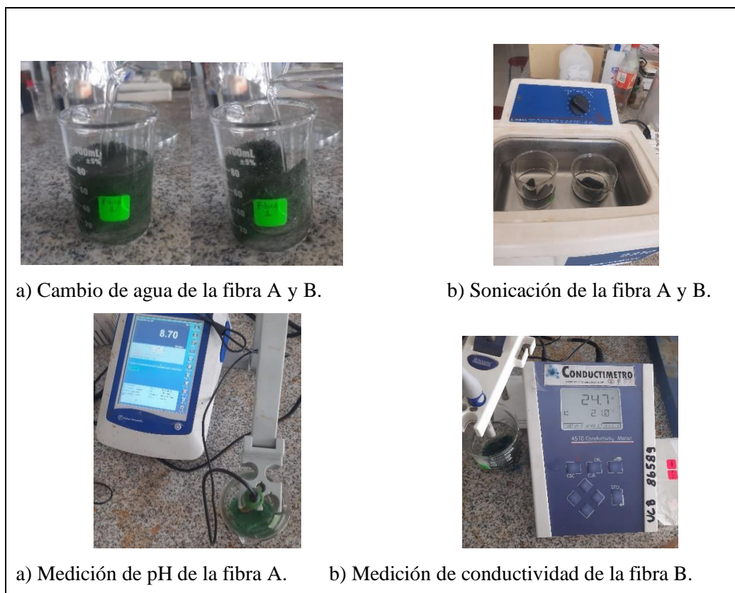
Ilustración 2-6: Lavados para reducir el pH de las fibras
