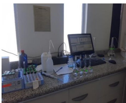
c) Calibración del equipo de EAA.
