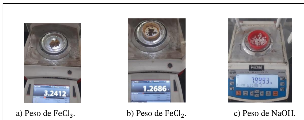
Ilustración 2-7: Pesos de cada reactivo utilizado para la síntesis de \text{Fe}_3\text{O}_4
