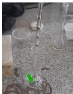
a) Extracción de 0.1 mL de estándar de Hg
