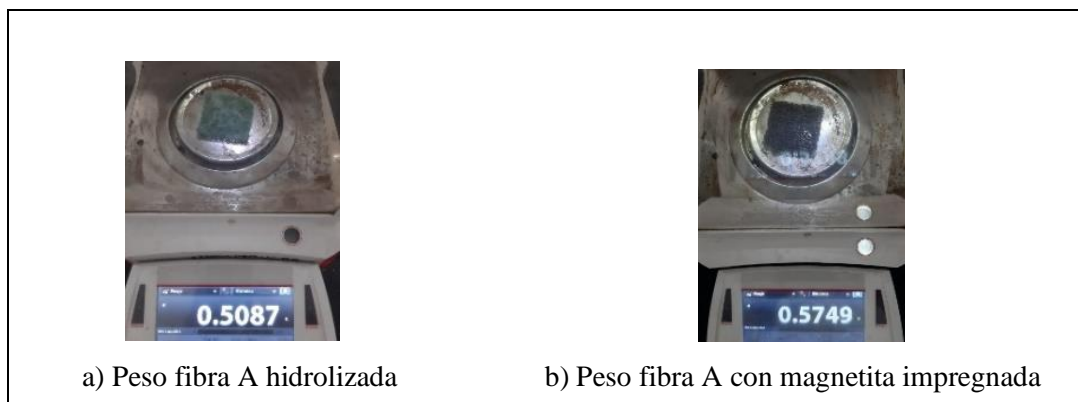
Ilustración 2-10: Peso de las fibras con NPMs
