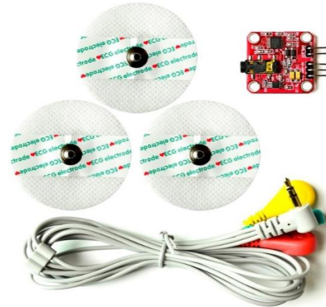
Ilustración 2-7: Sensor ECG /EMG 3,3v AD8832
