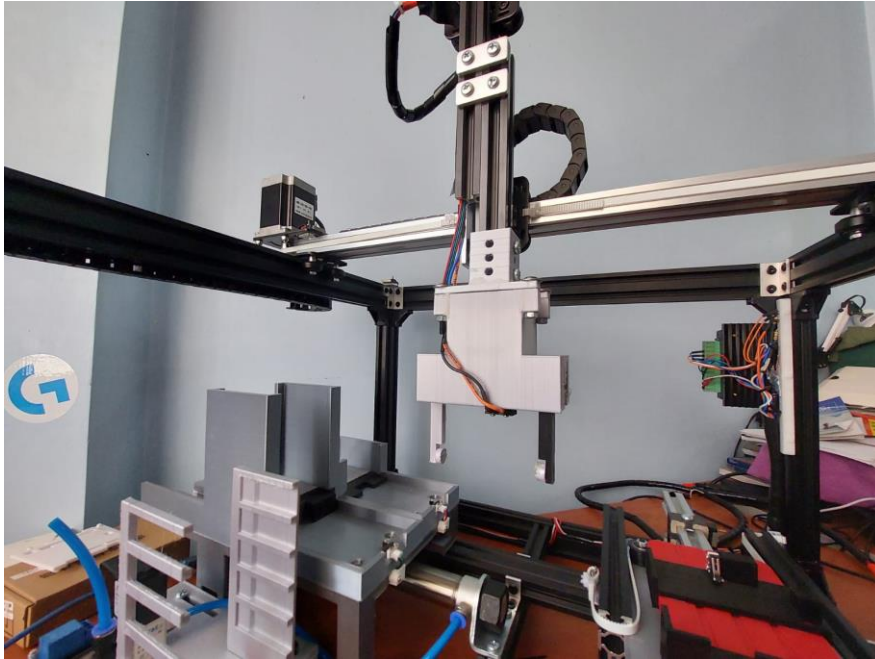
Ilustración 68-3: Ensamble del gripper en la estructura Realizado por: Bonilla, H., 2023
