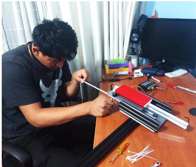
Ilustración 63-3: Ensamble del módulo de desplazamiento Realizado por: Bonilla, H., 2023
