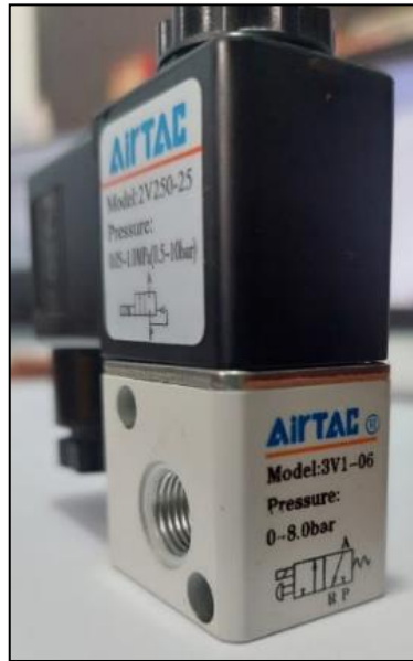
Ilustración 46-3: Electroválvula neumática Airtac 3V1-06 Realizado por: Bonilla, H., 2023
