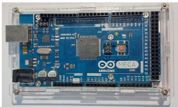
Ilustración 45-3: Tarjeta de desarrollo Arduino MEGA
