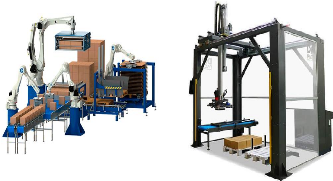
Ilustración 2-2: Ejemplo Paletizador por capas (iz) – Paletizador cartesiano (der).
