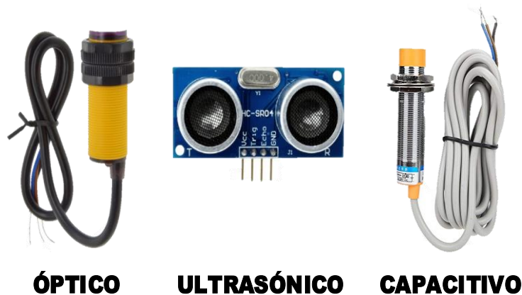
Ilustración 3-22: Sensores posición banda transportadora. Realizado por: Rosero L., Ramos G., 2023.
