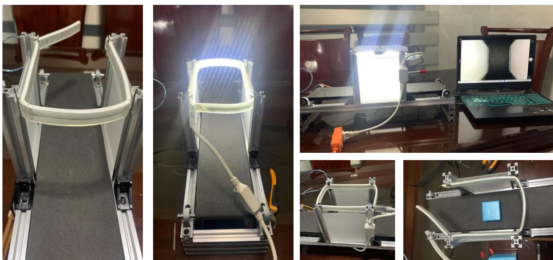
Ilustración 3-29: Construcción ambiente controlado para proceso de clasificación
