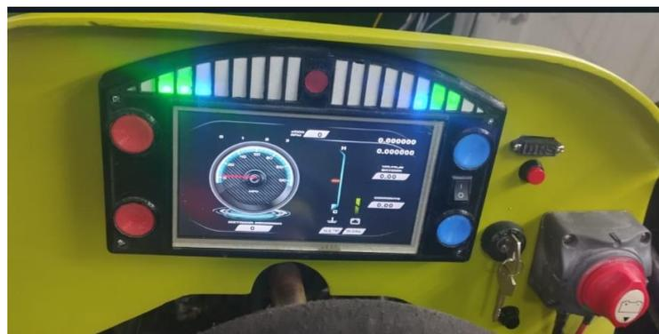
**Figura 25-3:** Montaje del tablero en el vehículo SAE
