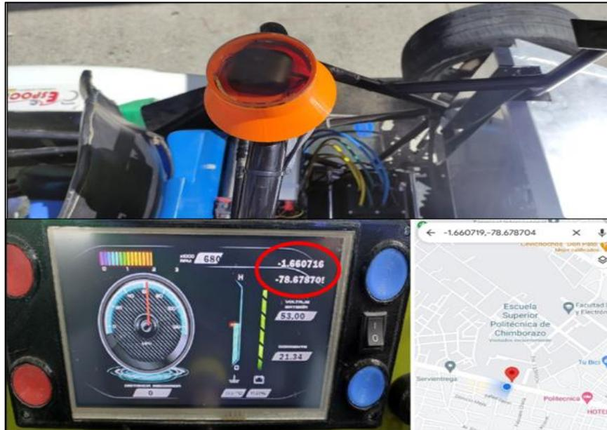
**Figura 15-4:** Ubicación de la antena GPS, visualización en la pantalla NEXTION, ubicación en el Google Maps
