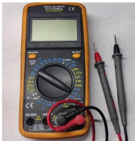
**Figura 10-4:** Multímetro digital DT9208A
