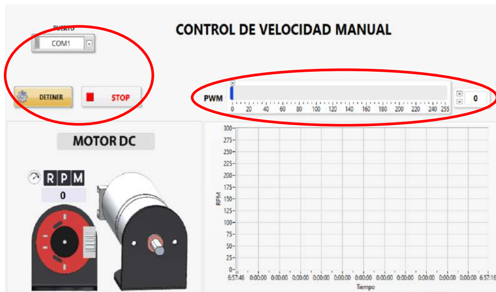
Ilustración 4-20: Controles numéricos, booleanos y paleta de selección en panel frontal de la práctica de control de velocidad manual
