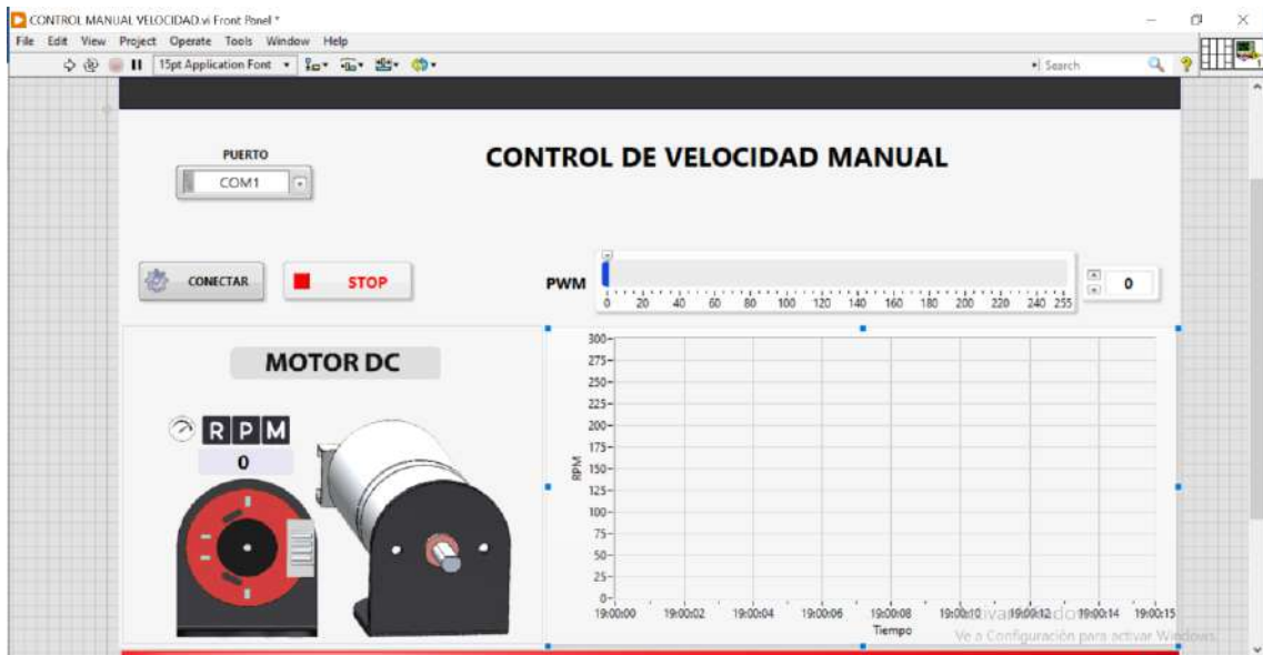
Ilustración 3-22: Panel frontal de la práctica de control manual de velocidad del motor DC Realizado por: Cevallos, Daniel, 2023.
