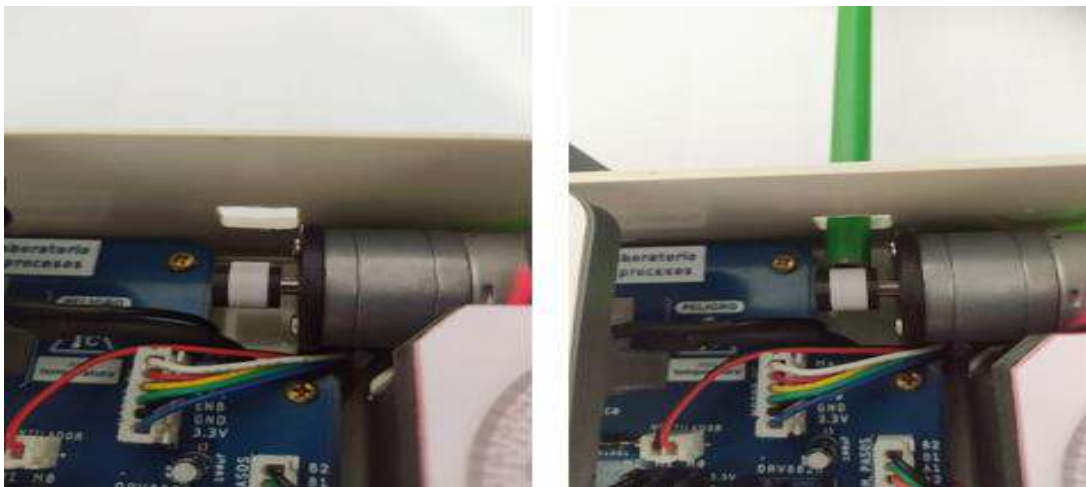
Ilustración 4-41: Frenado de eje del motor para generar perturbación en el proceso de velocidad
