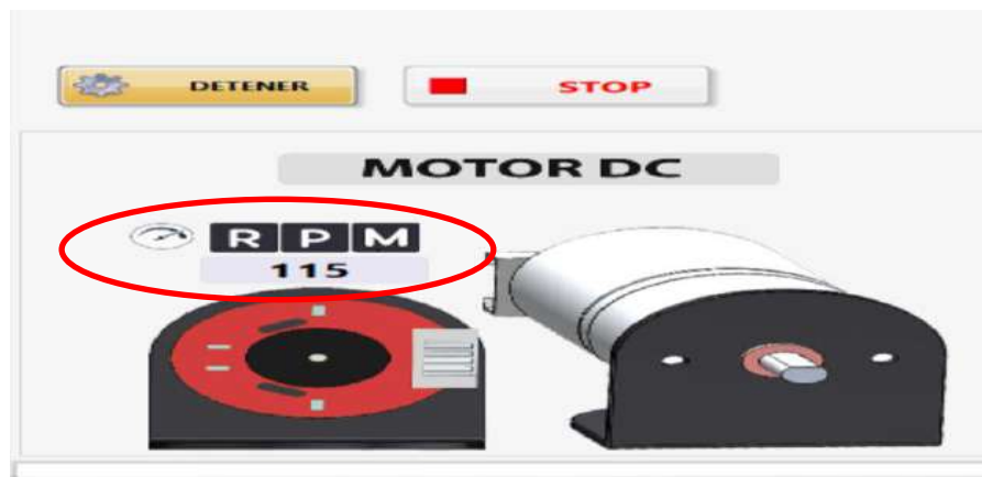
Ilustración 4-23: Velocidad en RPM generada por la señal PWM ingresada al sistema
