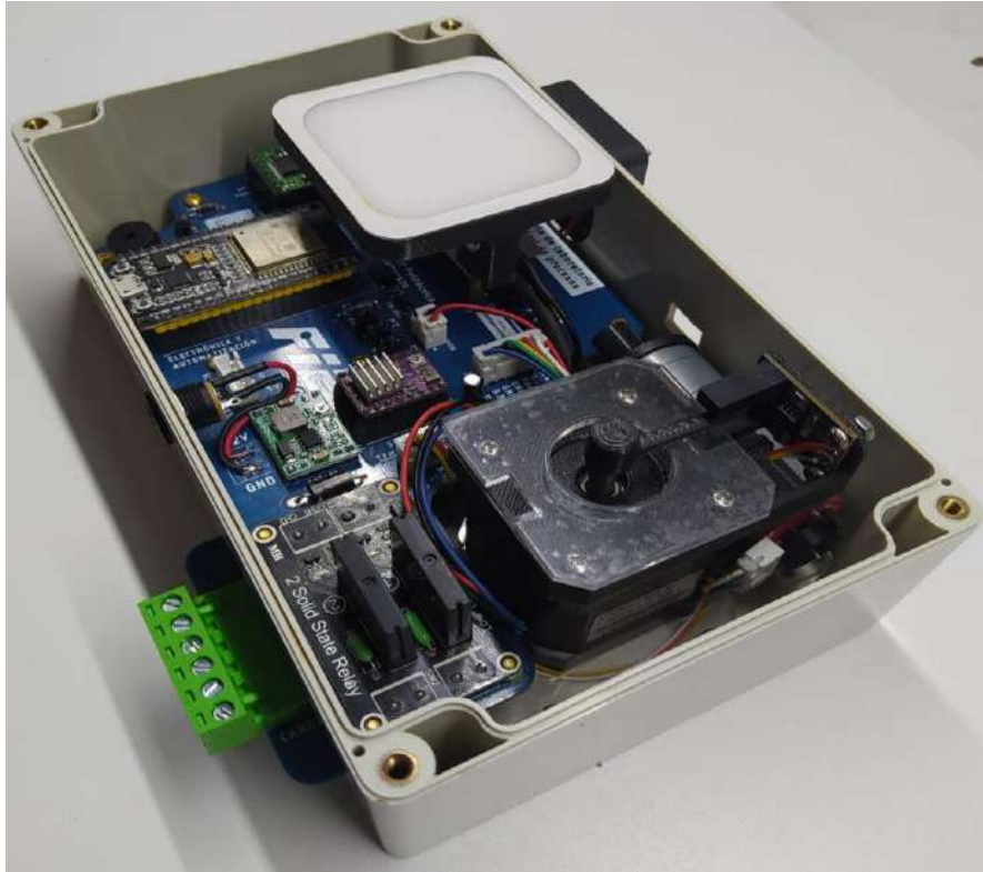
Ilustración 3-29: Montaje final de la placa PCB y demás elementos dentro de la caja de conexiones Heyiarbeit.
