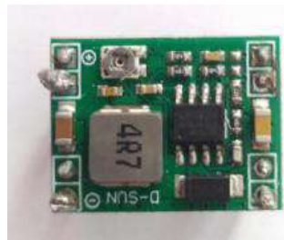
Ilustración 3-5: Fuente conmutada MP1584
