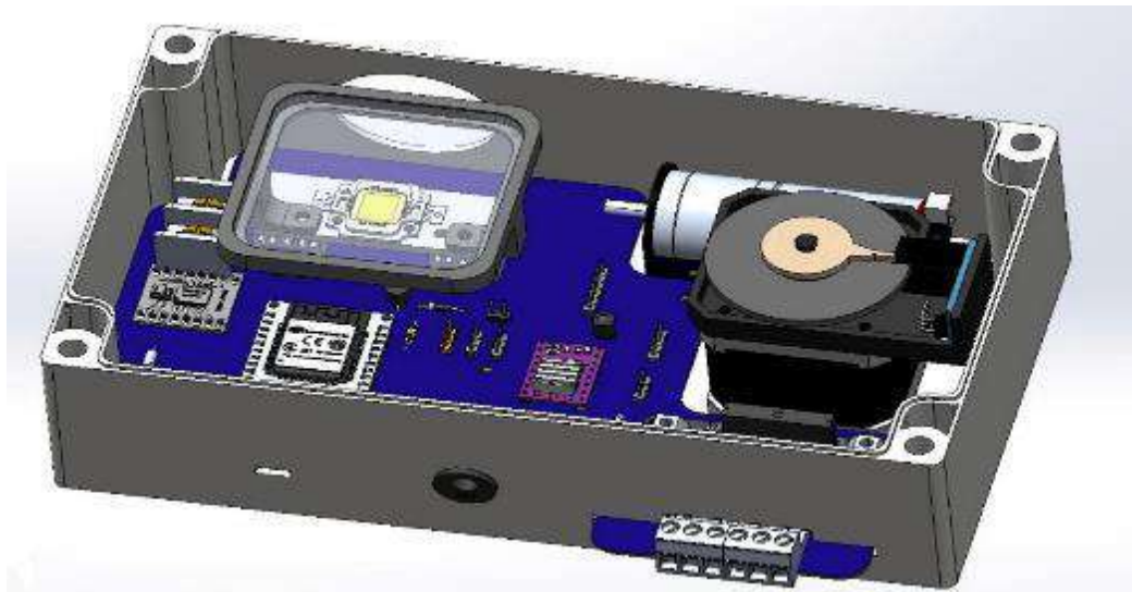
Ilustración 3-28: Diseño 3D del Montaje de placa PCB dentro de la caja de conexiones Heyiarbeit
