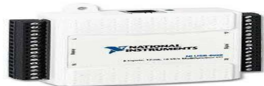
Ilustración 2-8: DAQ 6009 LabVIEW con entradas analógicas y digitales
