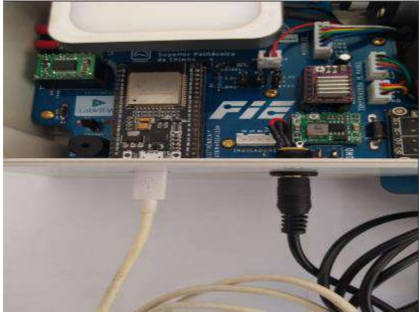
Ilustración 4-15: Conexión de cable de alimentación y comunicación
