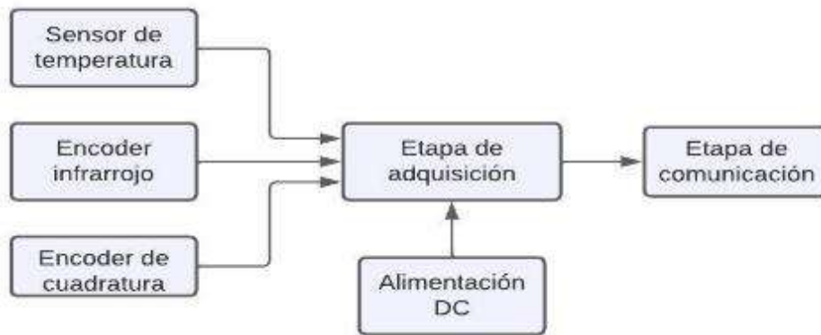
Ilustración 3-2: Diagrama de bloques de la etapa de adquisición y comunicación
