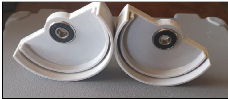
Ilustración 3-17. Acoplamiento del rodamiento en las chumaceras
