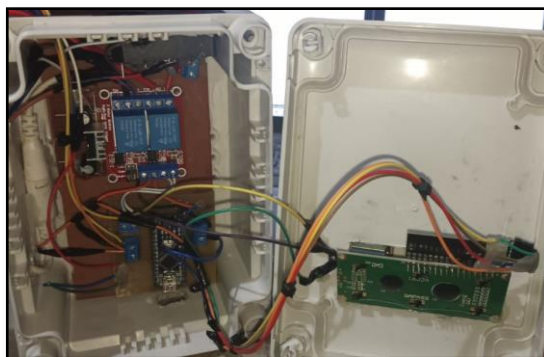
Ilustración 3-35. Caja de conexiones para el control de nivel del sistema
