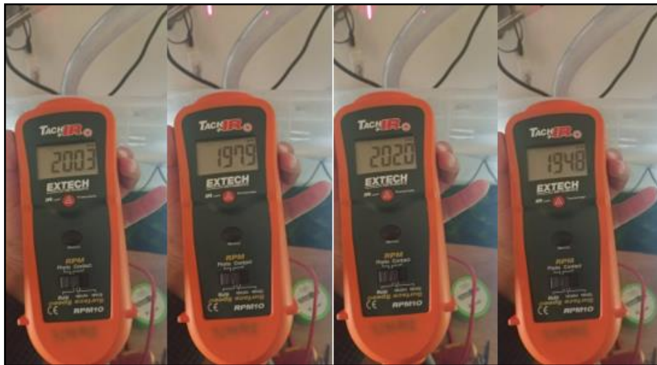
Ilustración 4-6. Medición de las revoluciones por minuto en la turbina helicoidal mediante el tacómetro
