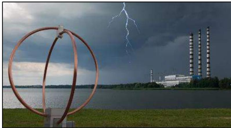
**Ilustración 2-15:** Sensor de Detección de rayos Linet
