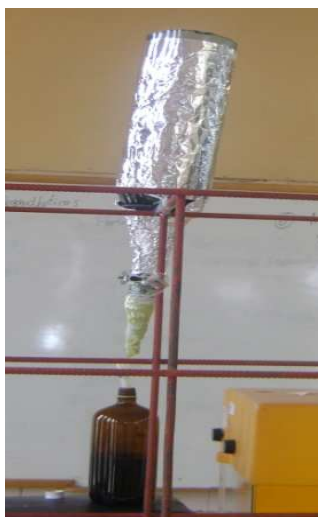
FOTOGRAFIA Nº 3 MÉTODO DE PERCOLACIÓN PARA LA OBTENCIÓN DE LOS EXTRACTOS
