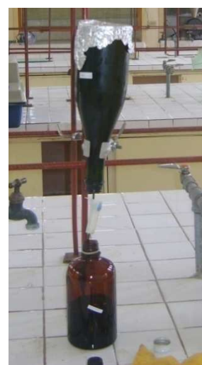
FOTOGRAFIA Nº 3 MÉTODO DE PERCOLACIÓN PARA LA OBTENCIÓN DE LOS EXTRACTOS
