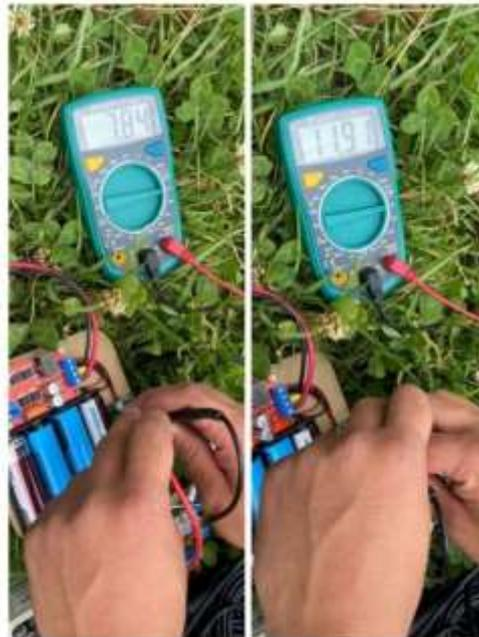
**Ilustración 4-17:** Funcionamiento del Convertidor en Modo Boost
