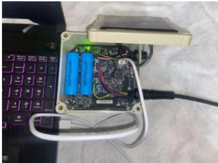
**Ilustración 3-10:** Conexión USB del controlador a la PC
