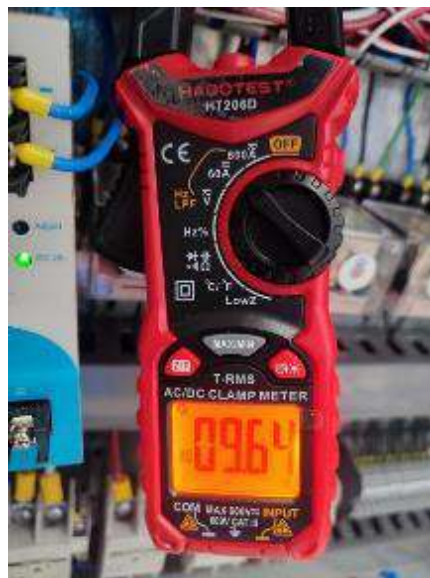
Figura 3-4: Medición de corriente de consumo de la máquina.
