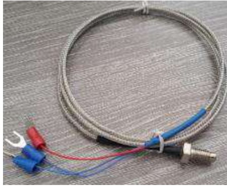
Figura 8-3: Sensor de temperatura pt100 con tipo de rosca M6.
