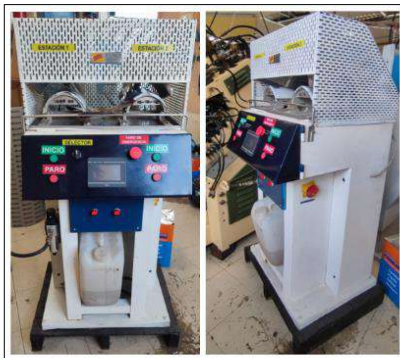
Figura 1-4: Máquina vaporizador para armado de puntas de calzado repotenciada.
