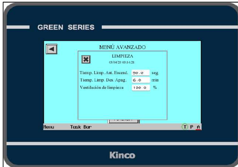
Ilustración 1-4: Etapa de limpieza del quemador PellasX.
