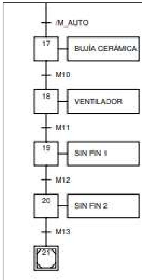
Ilustración 35-3: Diagrama grafcet del programa en modo manual.
