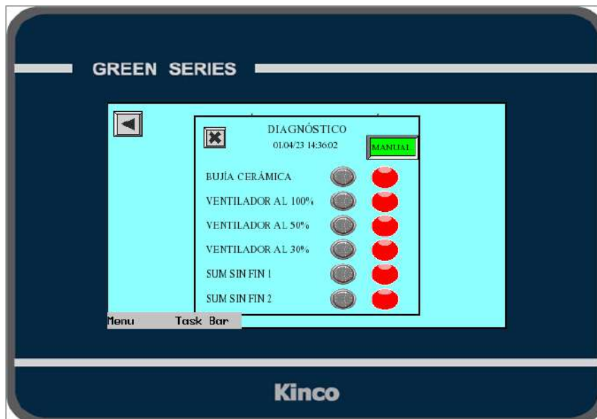
Ilustración 46-3: Control Manual del equipo del HMI.
