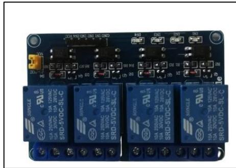
**Figura 15-3:** Módulo relé de cuatro canales
