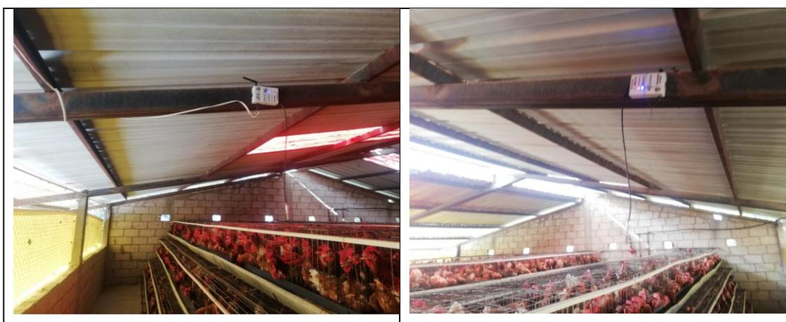
**Figura 13-4:** Nodos de adquisición ubicados en el centro del galpón
