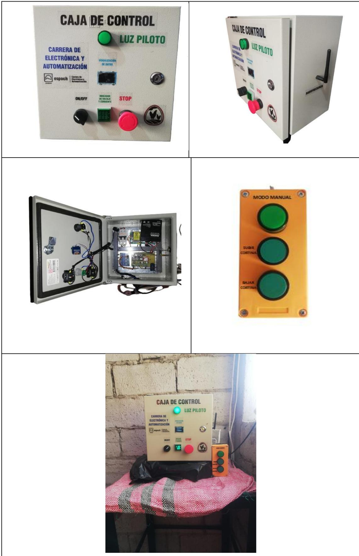
**Figura 31-3:** Caja central y botonera de control manual
