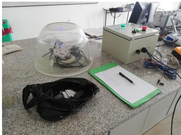
**Proceso 2:** Colocar el carbón activado, el amoníaco líquido y el sensor dentro del encapsulado
