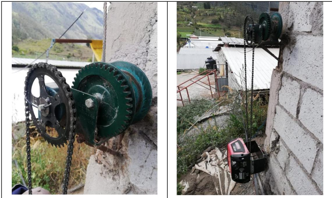
**Figura 40-3:** Acoplamiento del motor a las cortinas
