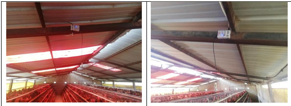
**Figura 12-4:** Nodos de adquisicion parte frontal del galpón
