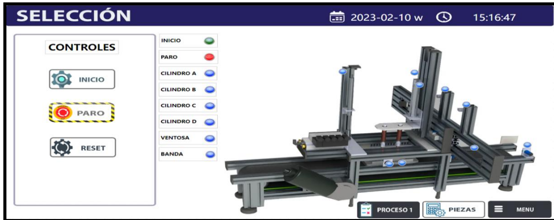
Figura 77-3: Estación de selección del cloud scada.
