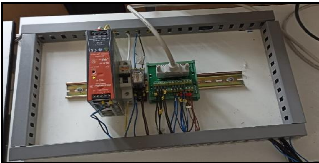
Figura 48-3: Implementación final del cuadro de control del módulo de evaluación.
