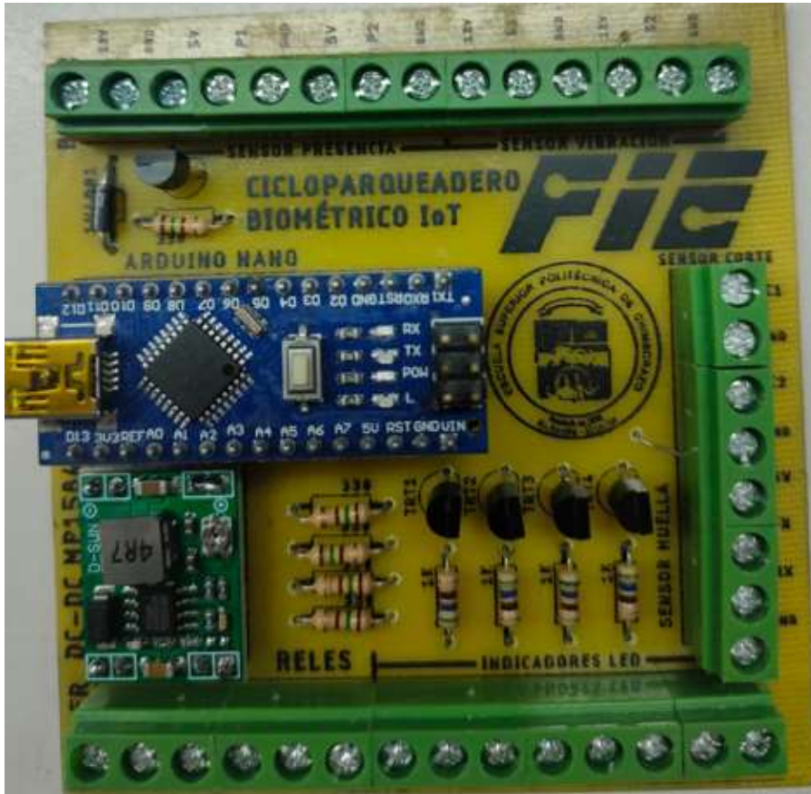
Figura 51-3: Placa PCB física del prototipo electrónico de seguridad biométrico.
