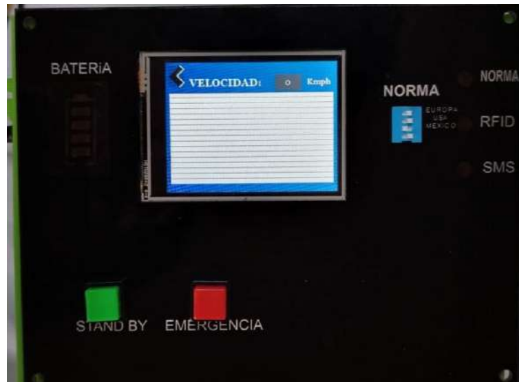
Ilustración 8-4. Visualizador del histórico y valor de velocidad vehicular.
