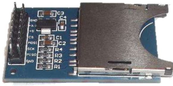
Ilustración 13-3. Módulo lector de tarjeta SD #SKU: 000035
