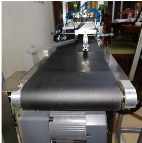
**Figura 37-3:** Sistema de transporte de tapas
