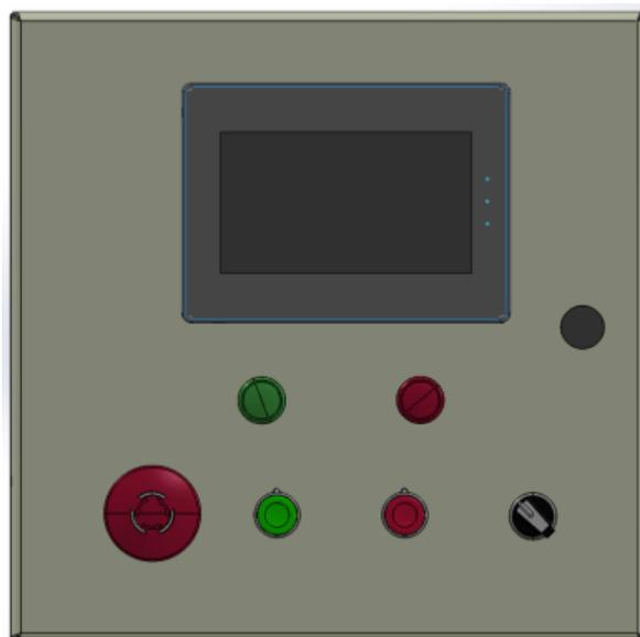
**Figura 36-3:** Vista frontal del diseño del tablero eléctrico
