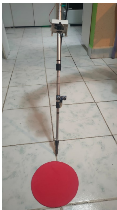
Figura 10-4: Módulo de cámara apuntando al color rojo. Realizado por: Fernández, M. 2022
