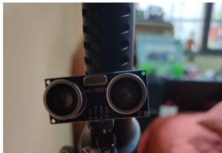
Figura 7-4: Sensor Ultrasonido superior midiendo. Realizado por: Fernández, M. 2022
