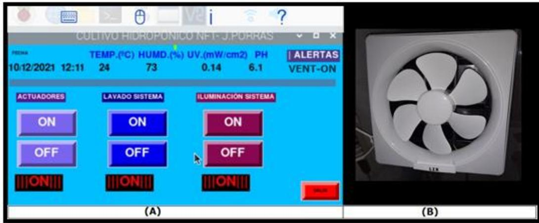
**Ilustración 6-4:** A) Activación alerta ventilador B) Activación ventilador.
