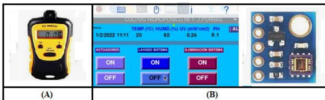
**Ilustración 3-4:** Medidor índice de radiación UV: A) Equipo patrón UV MS 98-3, B) Sensor ML 8511
