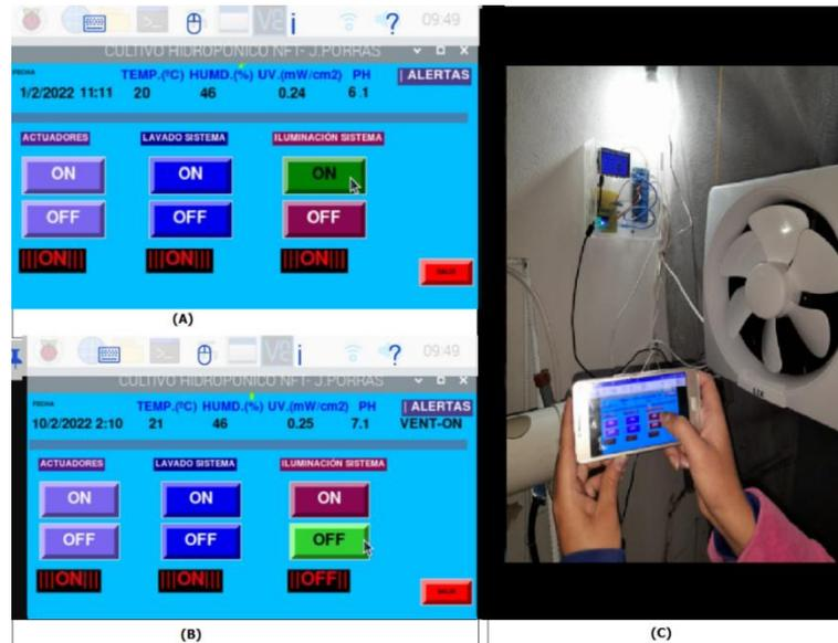
**Ilustración 12-4:** A) Activación iluminación sistema B) No activación iluminación sistema iluminación sistema.
