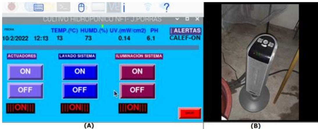
**Ilustración 7-4:** A) Activación alerta calefactor B) Activación calefactor
