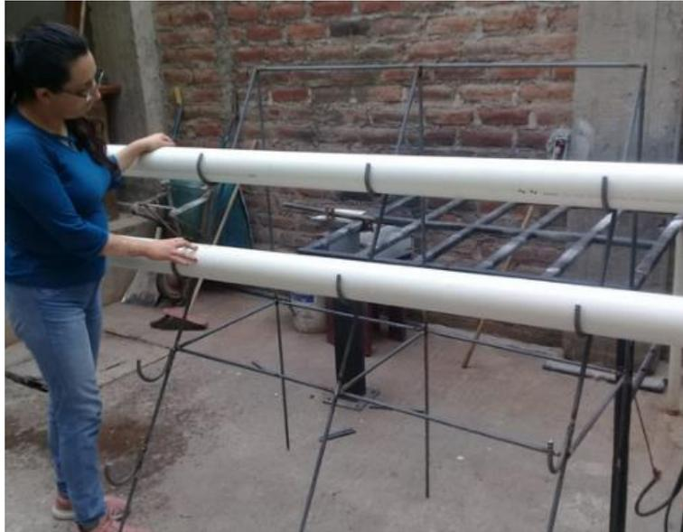
**Ilustración 25-3:** Estructura de soporte y sujeción cultivo hidropónico NFT automatizado.
