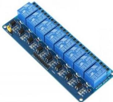
**Ilustración 12-3.** Módulo Relay X8
