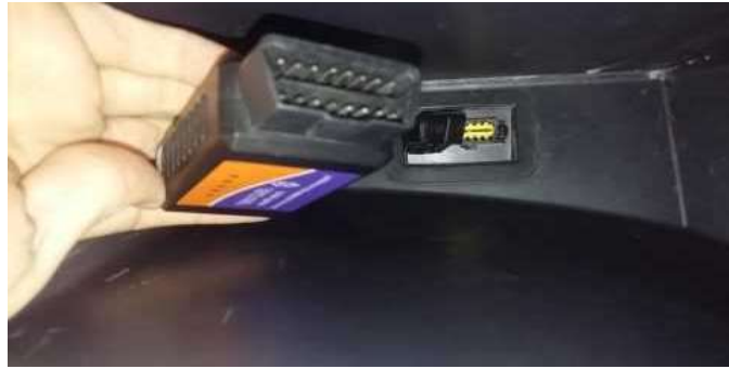
Ilustración 3-7: Instalación del dispositivo ELM OBDII
