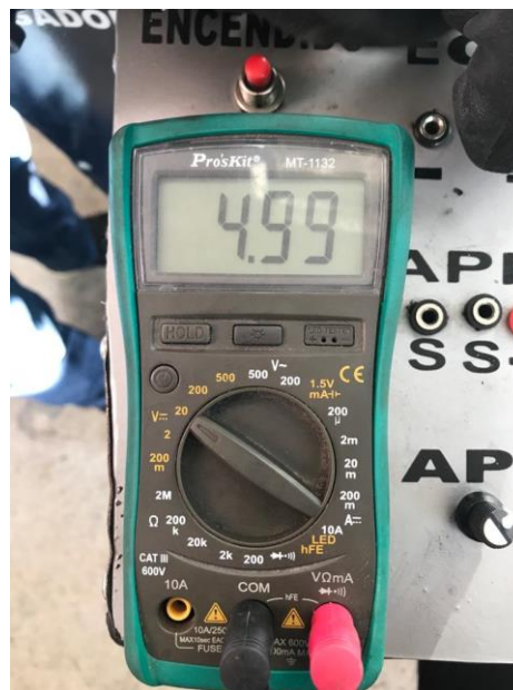
Ilustración 3-7: Voltaje de alimentación sensor CMP.
