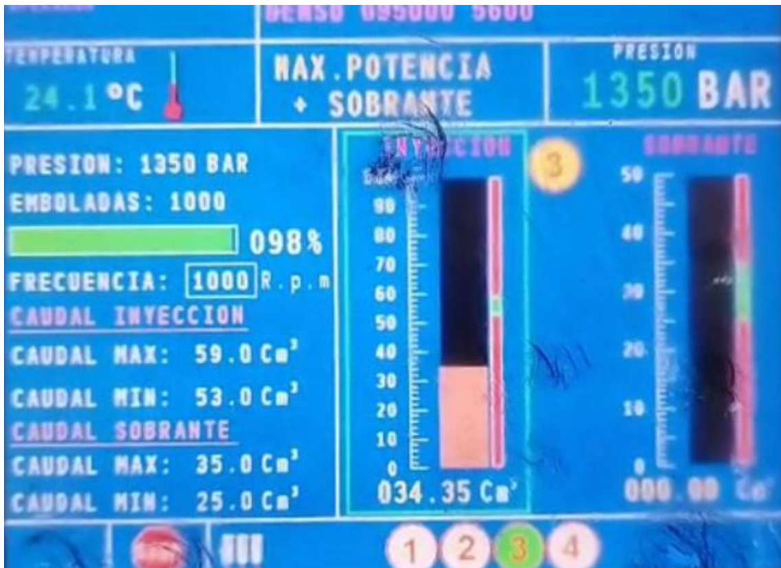
Ilustración 4-6: Presión de bomba CRDI.
