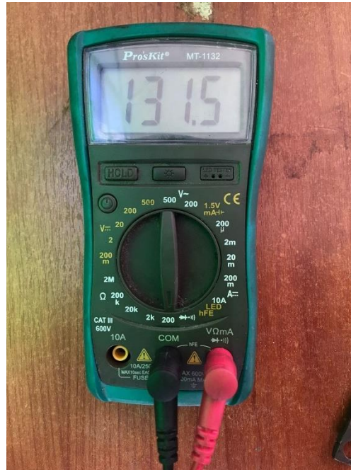
Ilustración 3-5: Resistencia sensor CKP.
