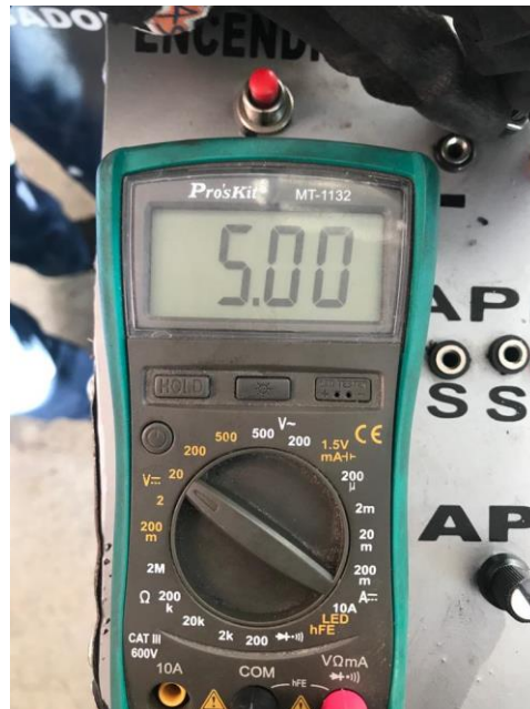
Ilustración 3-8: Voltaje de señal CMP en funcionamiento.
