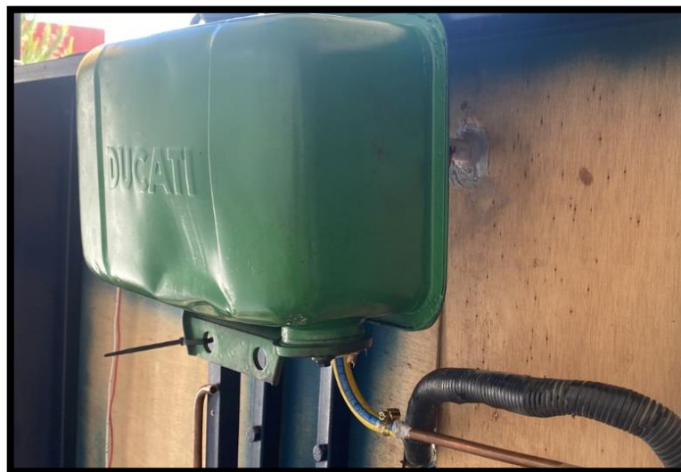
Ilustración 4-3: Tanque de combustible.
