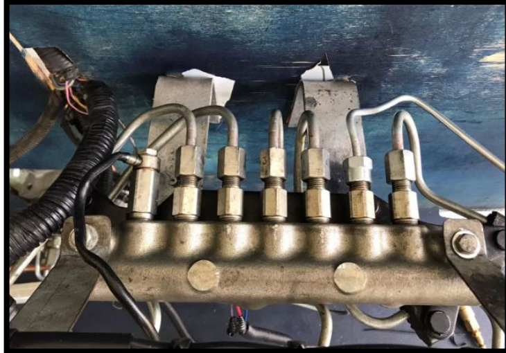
Ilustración 4-2: Acople cañería en el riel.
