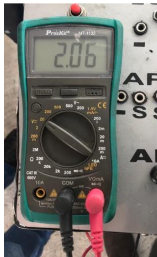
Ilustración 3-4: Voltaje sensor de presión de riel encendido.
