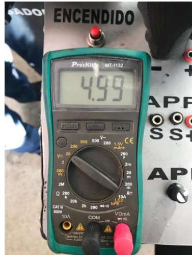
Ilustración 3-3: Voltaje sensor de presión de riel.
