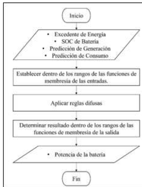
Ilustración 49-3: Diagrama de Flujo del Control Difuso.
