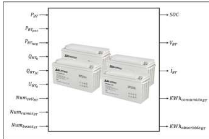
Ilustración 24-3: Sistema de Almacenamiento de Energía.
