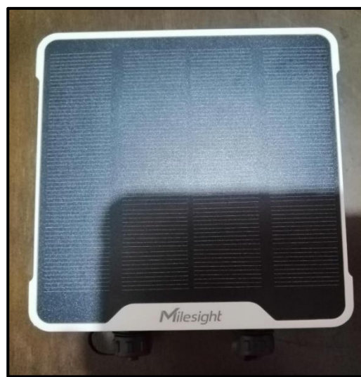
Ilustración 18-3: Controlador Lora UC501-915M.
