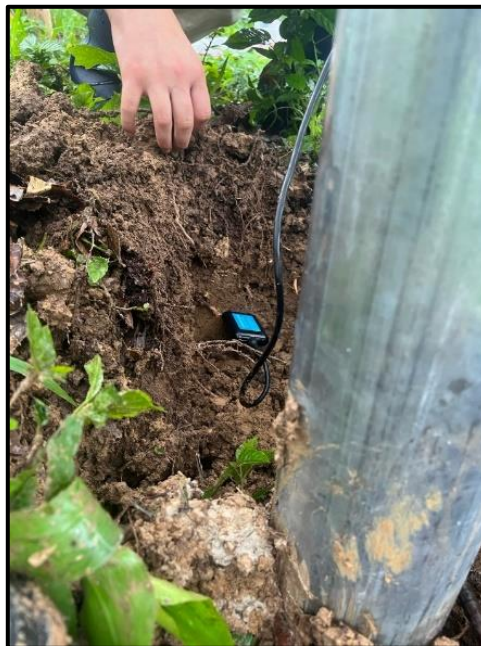
Ilustración 11-4: Ubicación del sensor NPK a 25cm.
