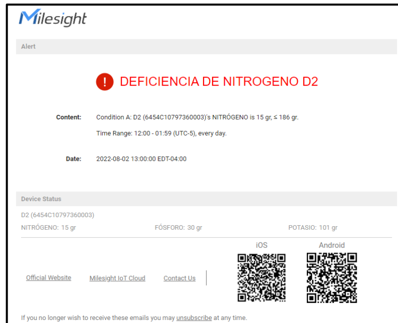
Ilustración 23-4: Informe de alarmas del primer controlador lora, al gmail por medio de Milesight IoT Cloud.
