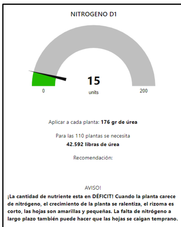
Ilustración 36-4: Lectura del sensor y recomendaciones en el dashboard de Node Red
