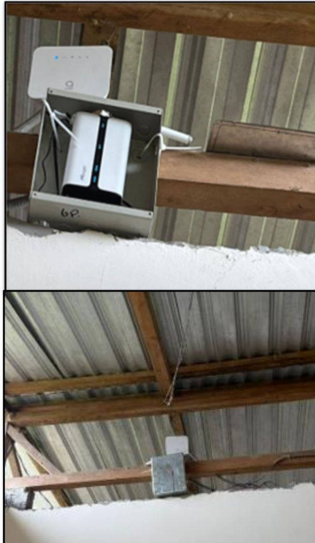
Ilustración 12-3: Gateway Lora en la casa de la finca La Belleza.
