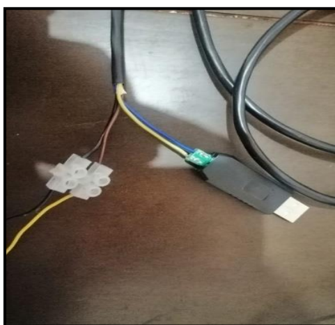
Ilustración 15-3: Conexión sensor NPK a convertidor RS485 a USB
