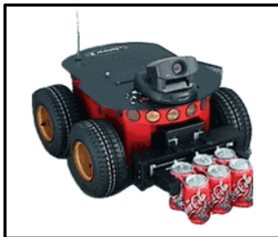
Figura 2-1. Robot con configuración dirección deslizante
