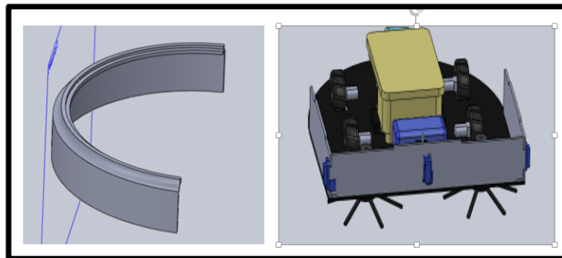
Figura 20-2. Diseño 3D del contorno de RAADUV
