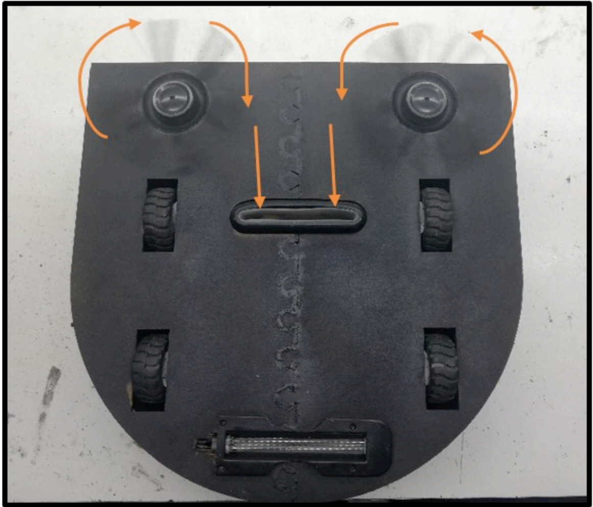
Figura 6-3. Escobillas del RAADUV con giro en sentido opuesto
