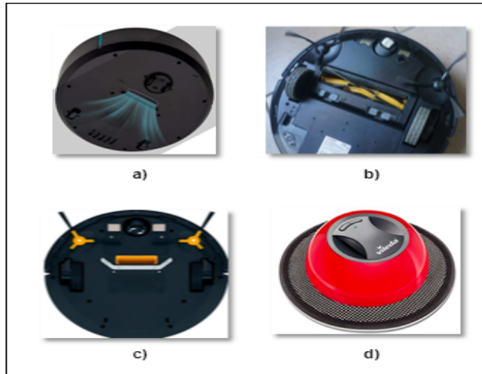
Figura 5-1. Tipos de robots móviles aspiradores autónomos. a) robot aspirador b) Robot aspirador con cepillo rotatorio, c) Robot aspirador con peines, d) Robot friegasuelos
