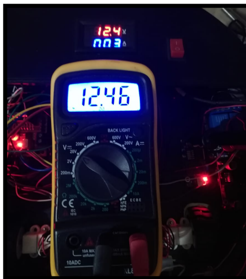
Figura 14-3. Voltaje de la batería de RAADUV a plena carga
