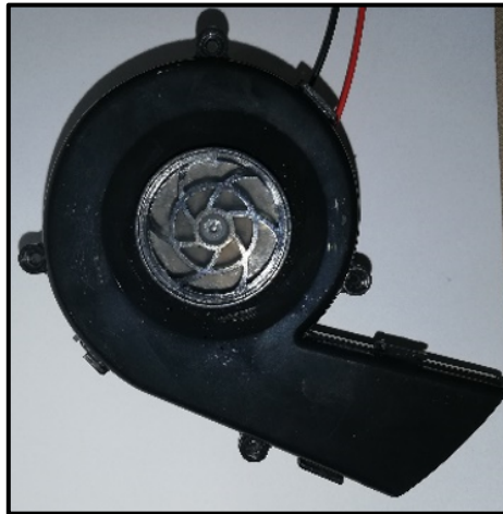
Figura 7-2. Aspirador implementado en RAADUV
