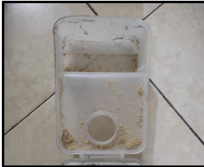
Figura 4-3. Evidencia de polvo en el contenedor de RAADUV
