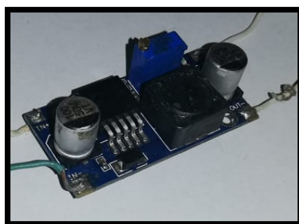
Figura 10-2. Regulador de voltaje LM2596
