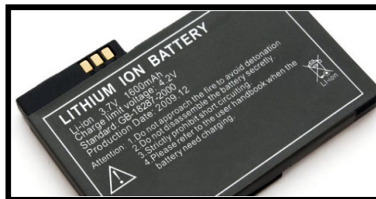
Figura 12-1. Batería ion litio
