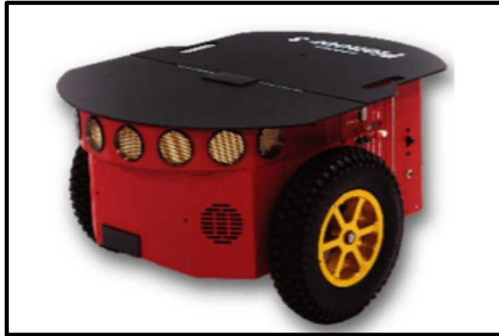
Figura 1-1. Robot con configuración Uniciclo
