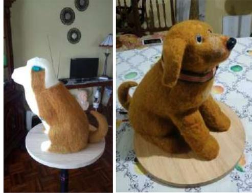
**Figura 5-2:** Fielto utilizado para crear el pelaje del robot TEO
