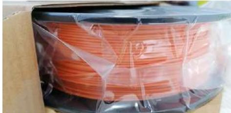
**Figura 3-2:** Rollo de filamento PLA
