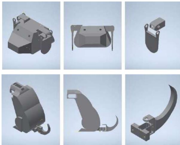
**Figura 15-2:** Diseño de orejas y cola del robot TEO
