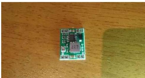
**Figura 29-2:** Módulo regulador de voltaje LM2596 mini
