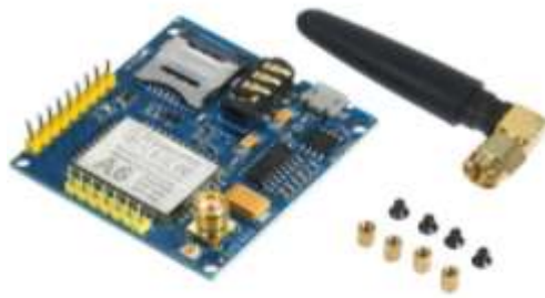
Figura 7-2: Vista anterior y posterior del módulo GSM
