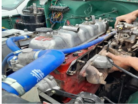
Ilustración 3-5: Procesos de desmontaje del carburador
