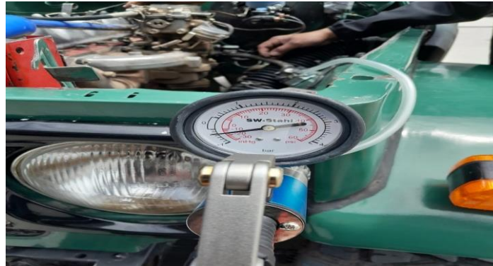
Ilustración 3-3: Medición de vacío del vehículo Toyota 2F
