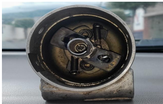
Ilustración 3-30: Fijación de avance en el distribuidor
