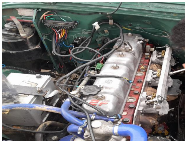
Ilustración 3-11: Colocación del riel de inyección
