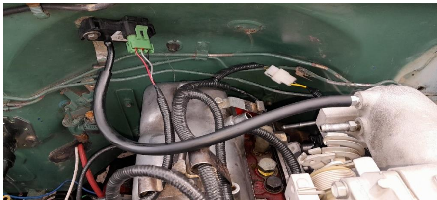
Ilustración 3-18: Ubicación del sensor MAP en el vehículo
