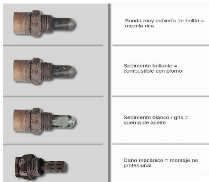
Ilustración 2-15: Estado de la sonda lambda
