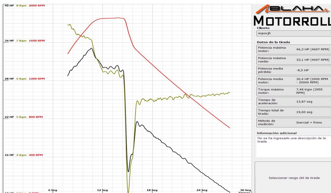
Ilustración 4-1: Grafica de torque y potencia con el sistema de alimentación a carburador
