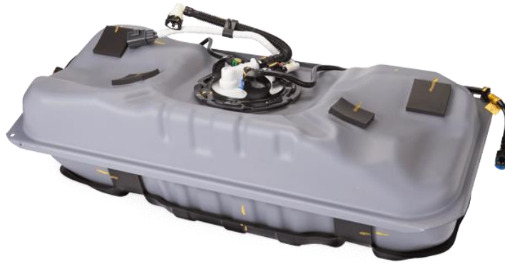
Ilustración 2-40: Depósito de combustible
