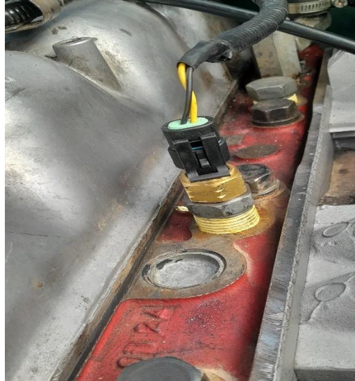
Ilustración 3-21: Ubicación del sensor de temperatura en el vehículo
