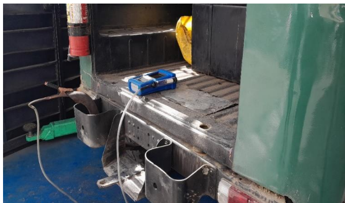
Ilustración 4-4: Pruebas de emisiones con sistema carburador
