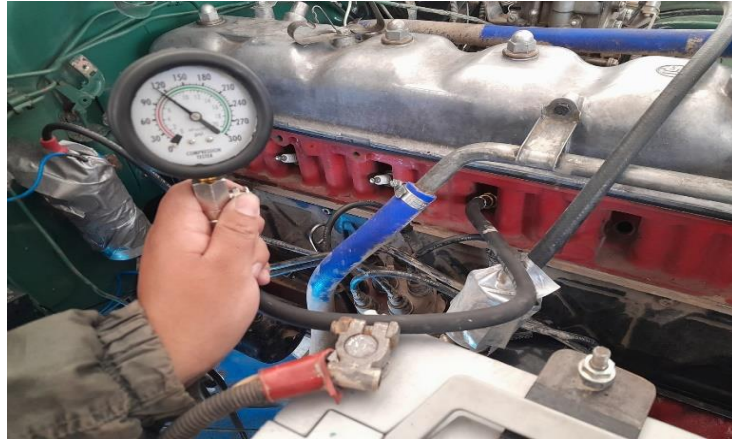
Ilustración 3-2: Medición de compresión del vehículo Toyota 2F
