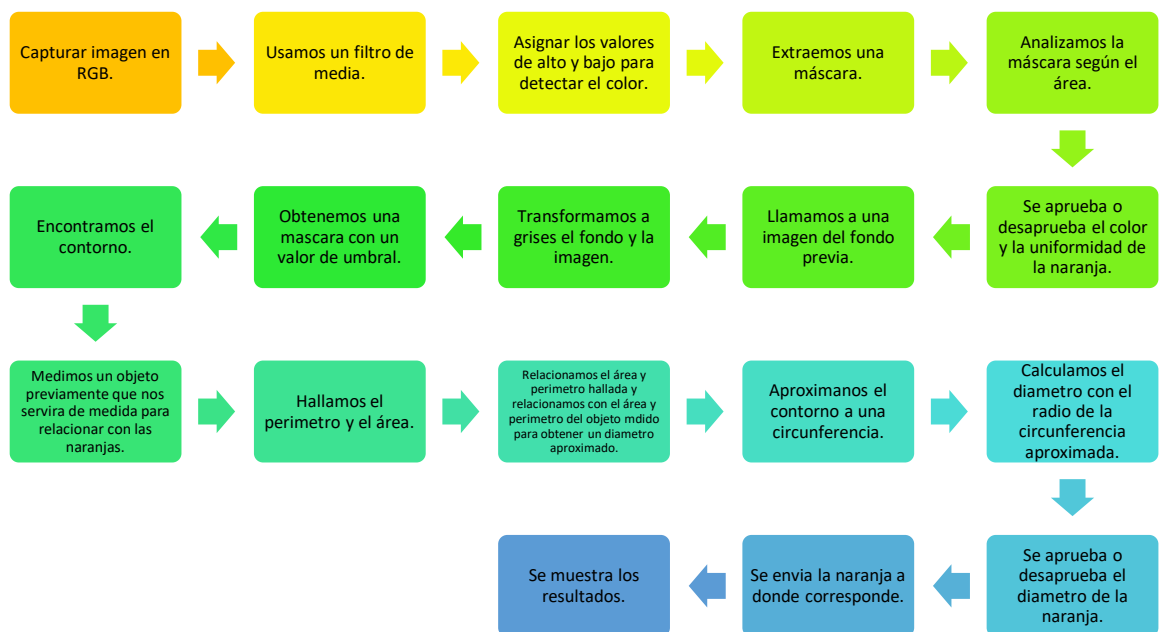
Gráfico 3-2. Etapas del Procesamiento de imágenes mediante visión artificial.
