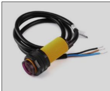
Figura 8-3: Sensor tipo switch E18 D8ONK
