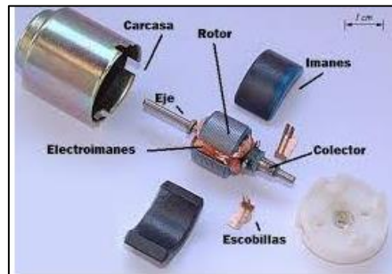
Figura 12-2: Componentes de un motor DC
