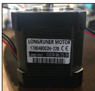
Figura 10-3: Motor paso a paso bipolar NEMA 17 Realizado por: Castro Carolina, 2022
