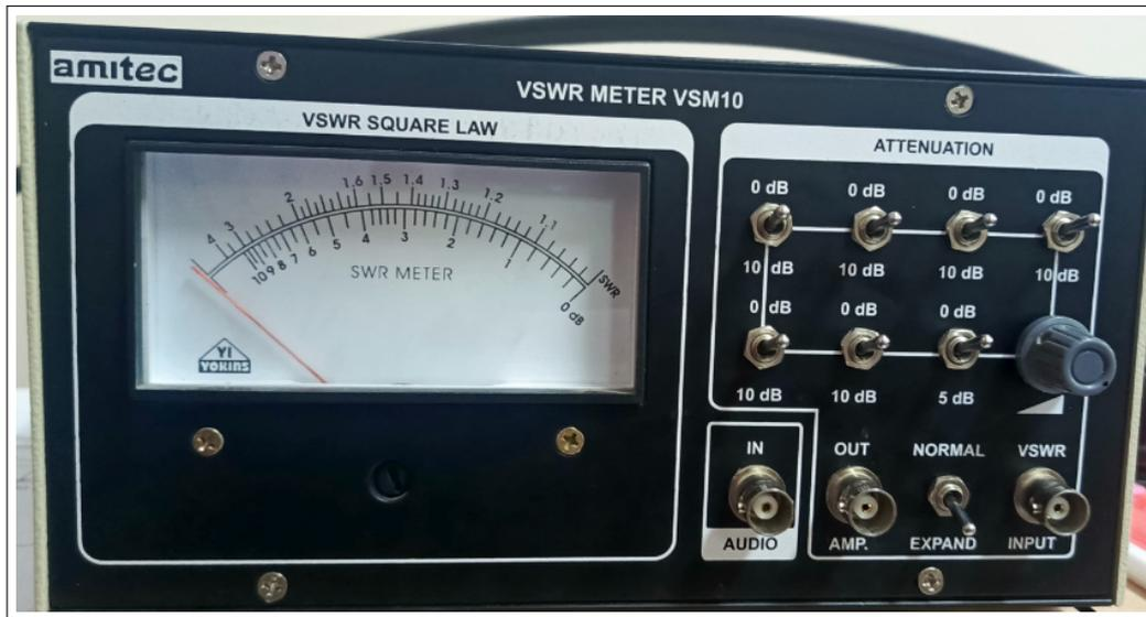
**Ilustración 2-31:** Medidor de ROE
