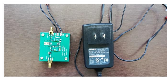
**Ilustración 3-34:** Preamplificador alimentado con 12 V
