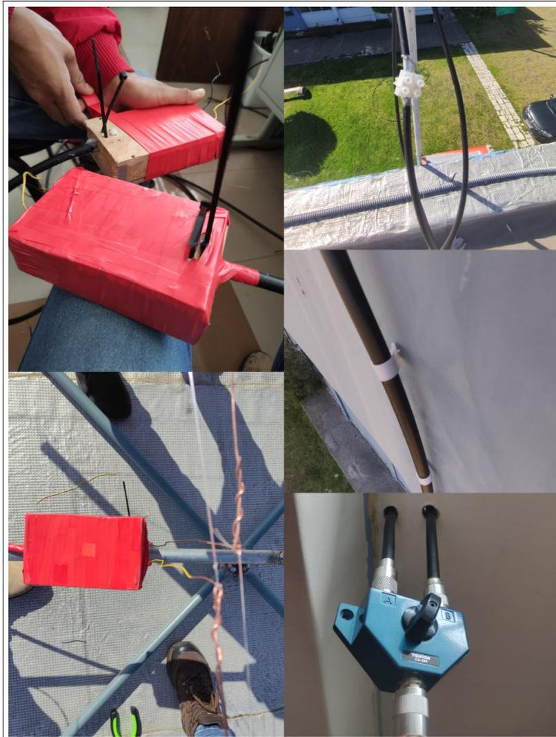
**Ilustración 3-61:** Acopladores de impedancia y tendido de cable coaxial hasta el Shack de Radioaficionados
