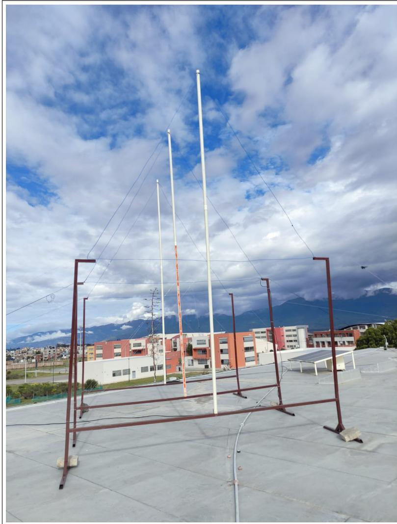
**Ilustración 3-51:** Antena Delta Loop sobre su estructura física
