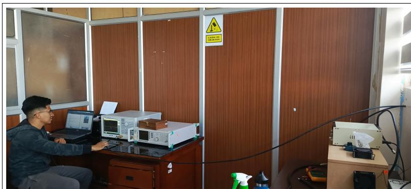
**M-1:** Medición de coeficiente de reflexión de la Antena Cuadra-Cúbica a 146 MHz
