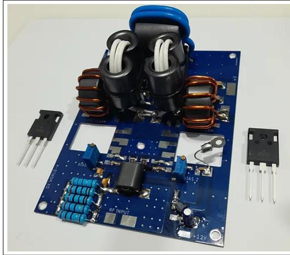
**Ilustración 2-14:** Amplificador Lineal LDMOS
