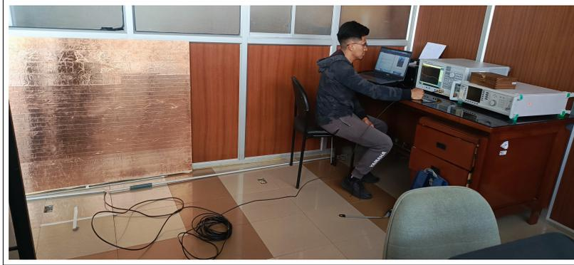
**K-1:** Medición de coeficiente de reflexión de la Antena DIPOLO
