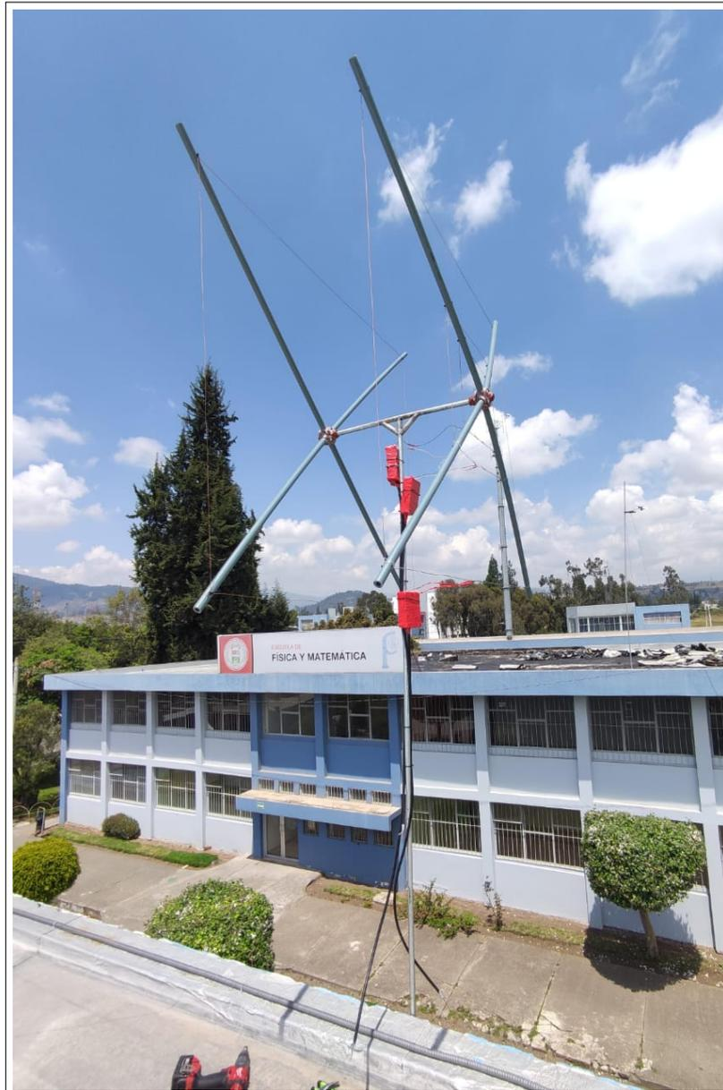
**Ilustración 3-62:** Antena Cuadra-Cúbica sobre su estructura física
