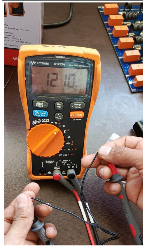
**Ilustración 3-33:** Medición de la Fuente de 12 V
