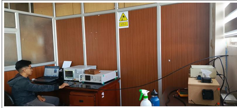
**N-1:** Medición de coeficiente de reflexión de la Antena Cuadra-Cúbica a 221 MHz
