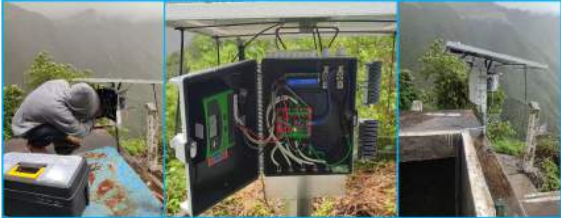
Ilustración 4-4: Implementación de nodo esclavo 2
