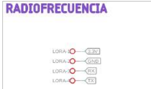
Ilustración 3-28: Esquema de conexión de módulo LoRa en Arduino nano
