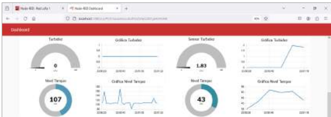
Ilustración 4-10: Visualización de datos de sensores en Dashboard Node-RED
