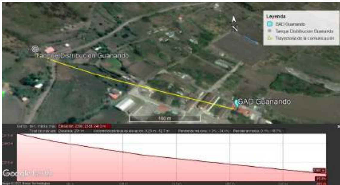
Ilustración 3-3: Análisis de trayectoria de comunicación desde tanque de Guanando hasta GAD Guanando en Google Earth
