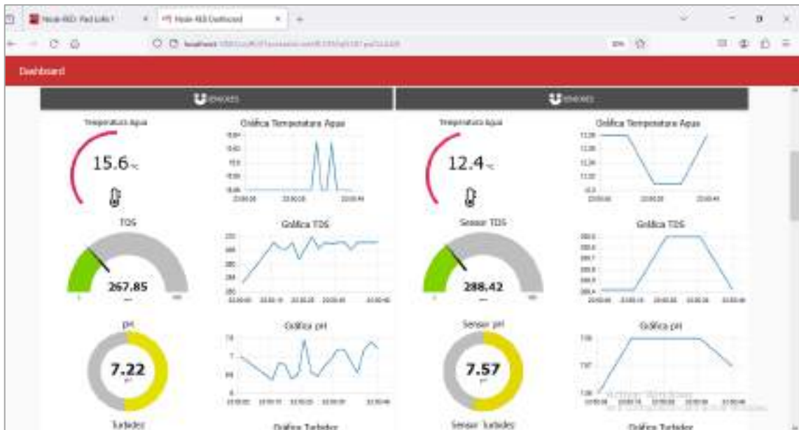
Ilustración 4-9: Visualización de datos de sensores en Dashboard Node-RED
