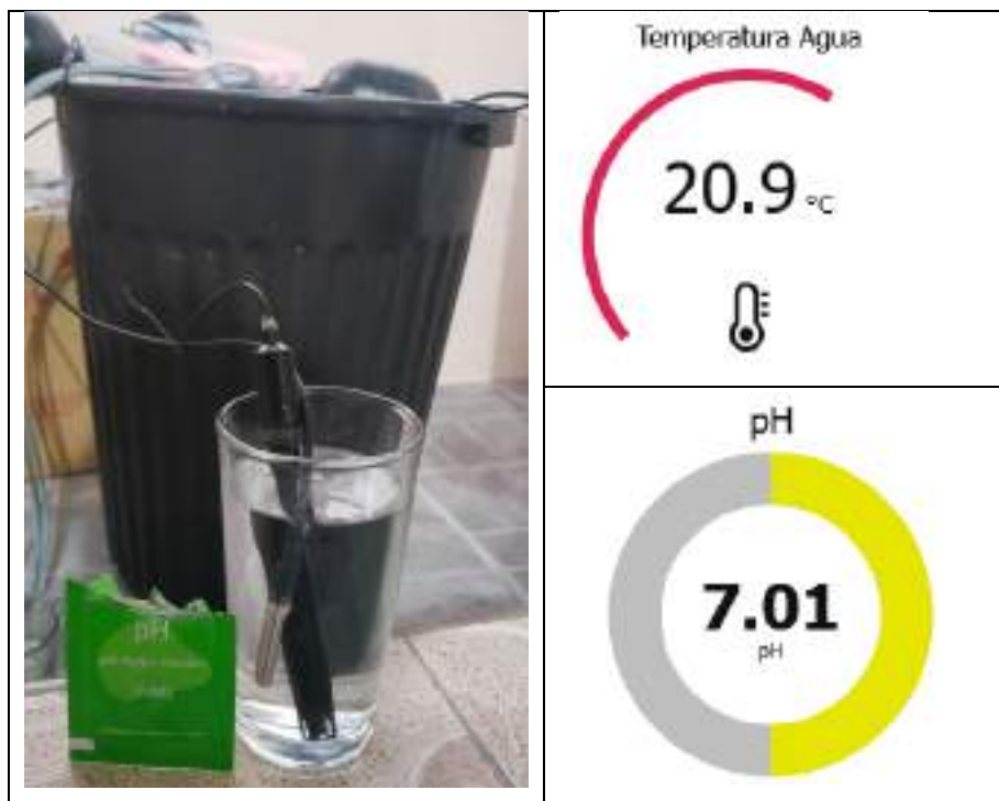
Ilustración 4-24: Calibración de pH 7
