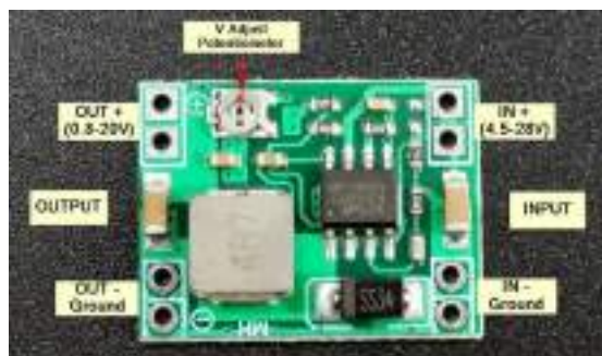
Ilustración 3-18: Convertidor de voltaje DC-DC Step-Down MP1584
