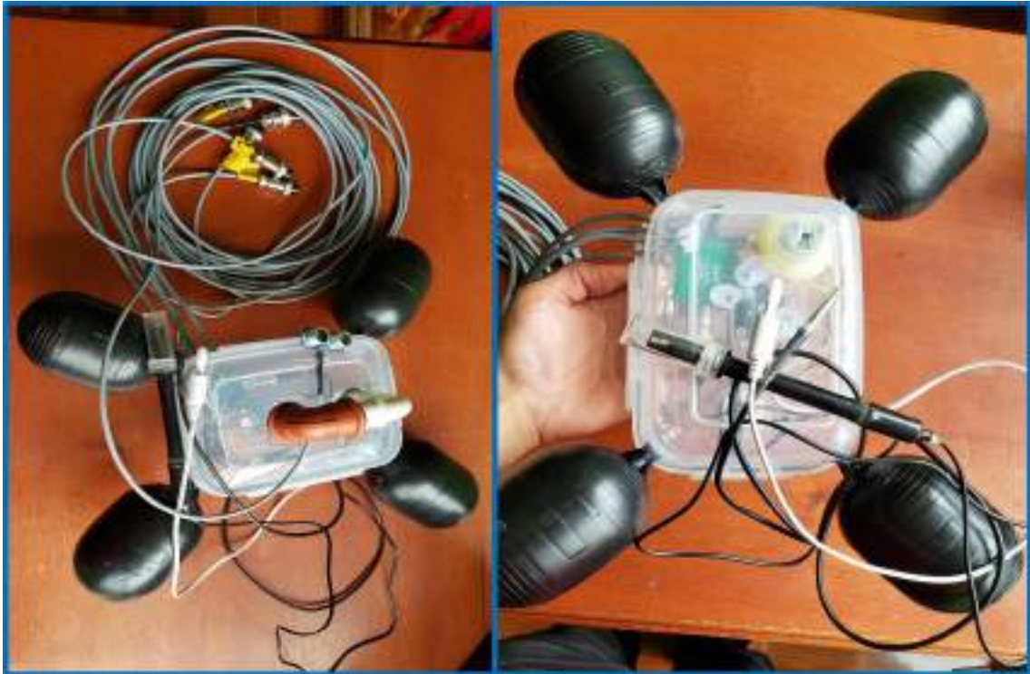
Ilustración 3-48: Construcción de sistema para ubicación de sensores
