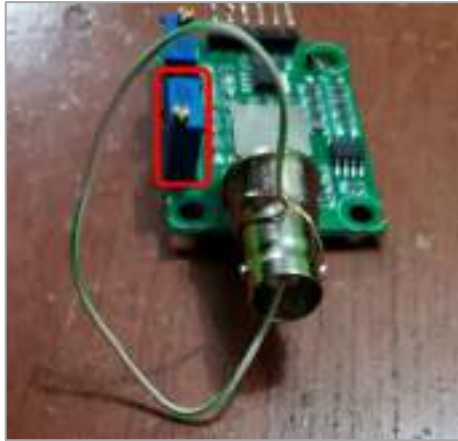
Ilustración 4-21: Calibración de voltaje de la tarjeta acondicionadora de pH
