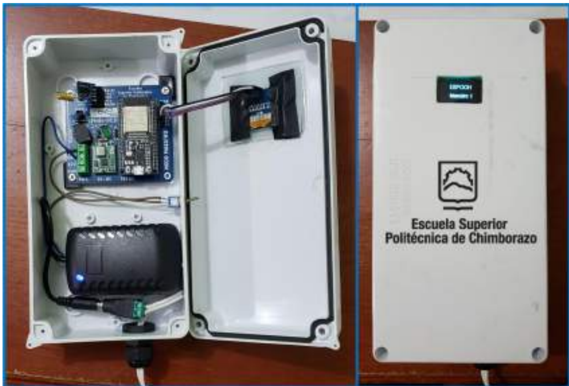
Ilustración 3-45: Construcción del nodo maestro
