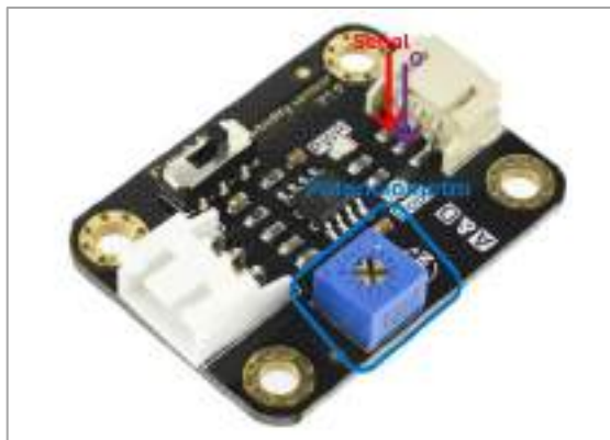
Ilustración 4-27: Calibración de tarjeta de adaptación para sensor de turbidez
