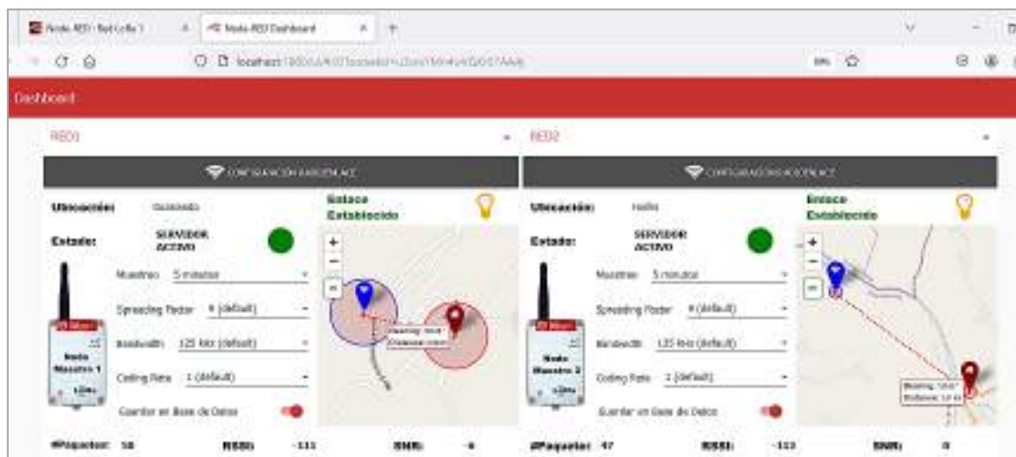
Ilustración 4-8: Configuración de enlace Dashboard Node-RED
