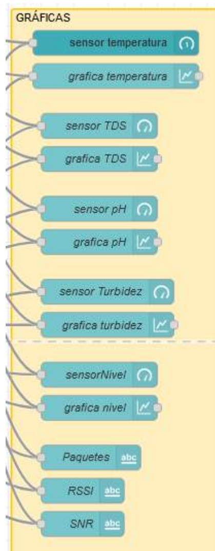
Ilustración 3-38: Bloque de programación para las gráficas y widgets
