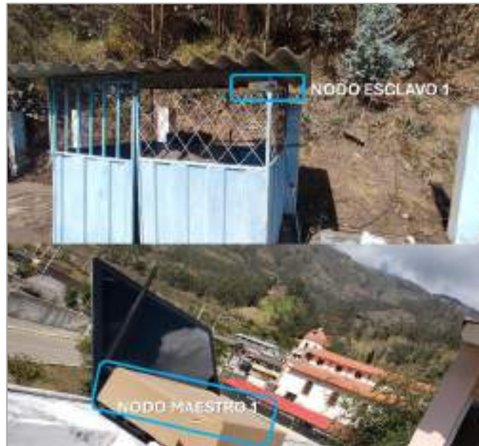
Ilustración 4-34: Prueba de cobertura de módulos LoRa RYLR998 en Guanando
