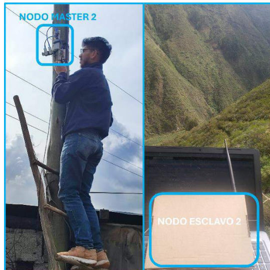
Ilustración 4-39: Prueba de cobertura de módulos LoRa RYLR993 en Huillis
