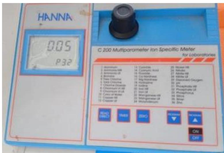
**Ilustración 3-5:** Espectrofotómetro Hanna para determinación de aniones.
