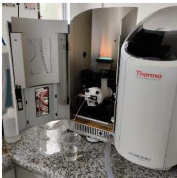
**Ilustración 3-6:** Fotómetro de llama para determinación de cationes
