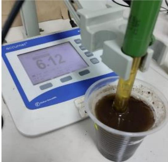
**Ilustración 3-10:** Medición de pH de muestras de suelos
