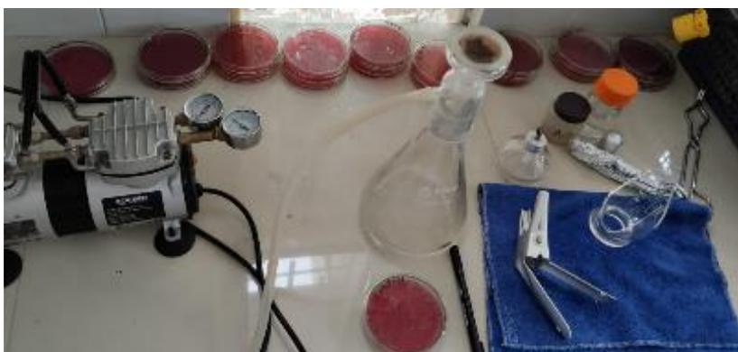
**Ilustración 3-7:** Equipo de filtración por membrana para coliformes
