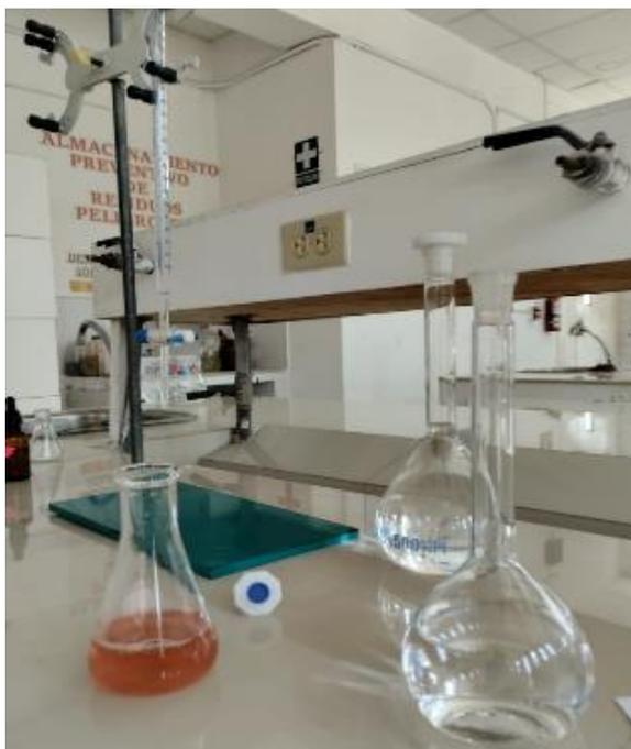
**Ilustración 3-9:** Titulación para determinación de carbonatos y bicarbonatos
