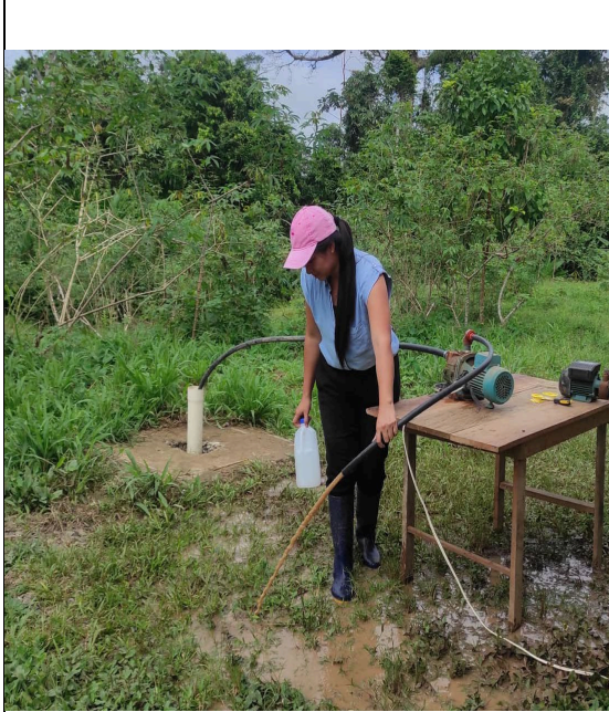
Fig.1. Purga de pozo
