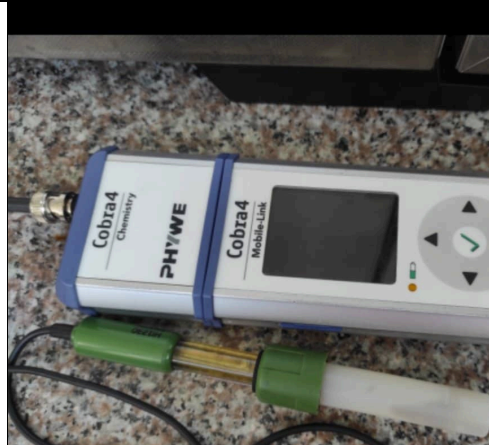
Fig.2. Multiparamétrico para medir la temperatura y oxígeno disuelto
