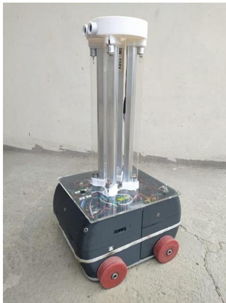
**Figura 28-3:** Estructura del robot con las lámparas UVC con ozono.
