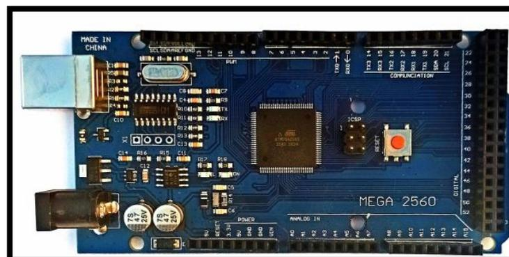
**Figura 2-3:** Arduino Mega 2560.
