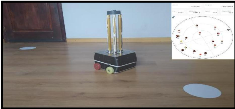
**Figura 33-3:** Proceso de pruebas de posicionamiento con GPS.
