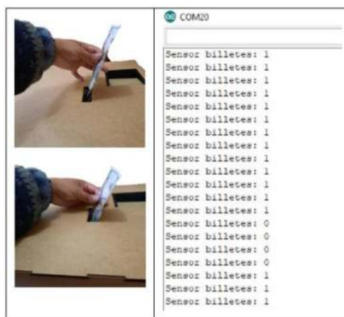
Figura 2-3: Toma de muestras sensor IR infrarrojo lector encoder óptico FC-03.
