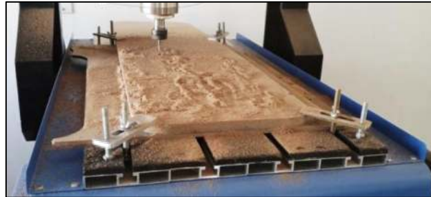
Figura 38-2: Cortes en CNC de las piezas.
