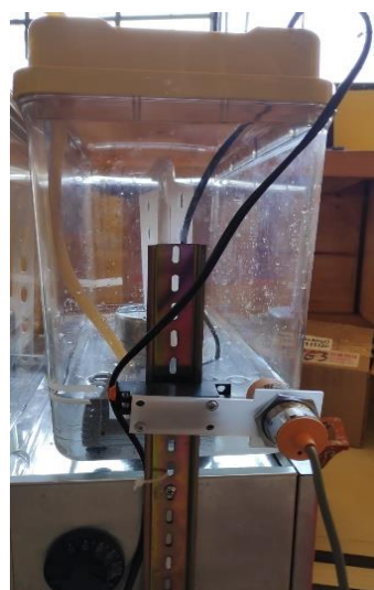
Figura 2-3: Ausencia de líquido en zona de censado
