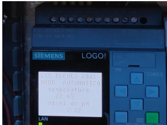
Figura 14-3: Visualización de pH y temperatura establecida
