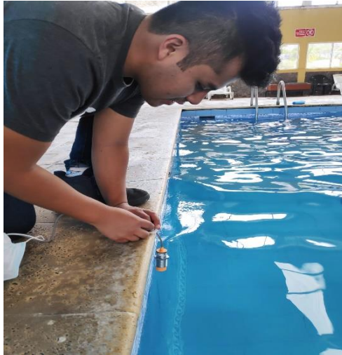
Figura 10-3: Toma de muestra con el sensor de nivel
