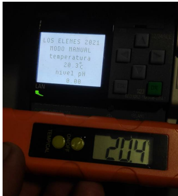
Figura 7-3: Validación del transmisor
