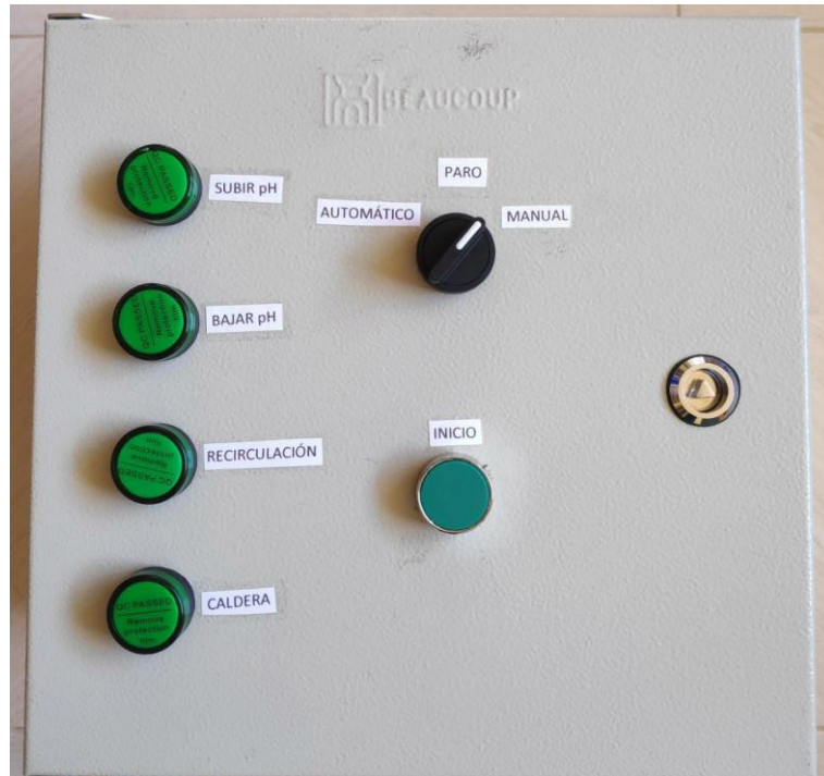
Figura 27-2: Implementación exterior de la caja de control
