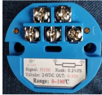
Figura 10-2: Transmisor de temperatura
