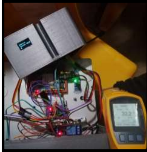
Figura 2-3: Prueba del sensor MLX90614.
