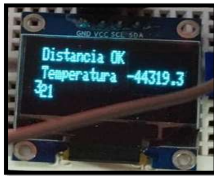
Figura 13-2: Ejemplo de la visualización en pantalla OLED.
