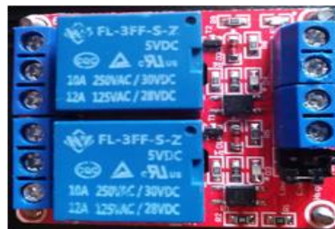
Figura 46-2: Módulo de relé Fuente: Pilco, Eliana,2021
