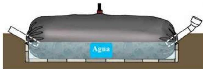
**Ilustración 2-4:** Biodigestor modelo tubular.
