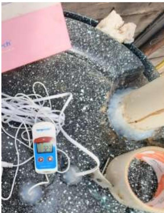
**ANEXO G: COLOCACIÓN E INSTALACIÓN DEL SENSOR GSP-6 MULTI-USE TEMPERATURE & HUMIDITY DATA LOGGER EN EL INTERIOR DEL BIODIGESTOR**
