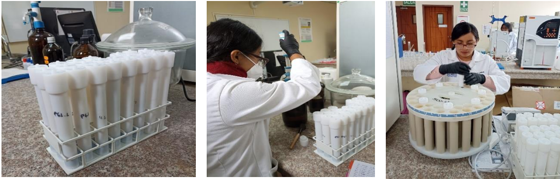
Ilustración 23-2: Digestión de las muestras para la determinación de metales pesados Realizado por: Barahona, V; Cargua, N, 2022
