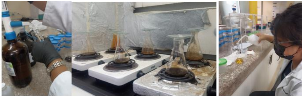
Ilustración 22-2: Digestión de las muestras para la determinación de metales pesados Realizado por: Barahona, V; Cargua, N, 2022
