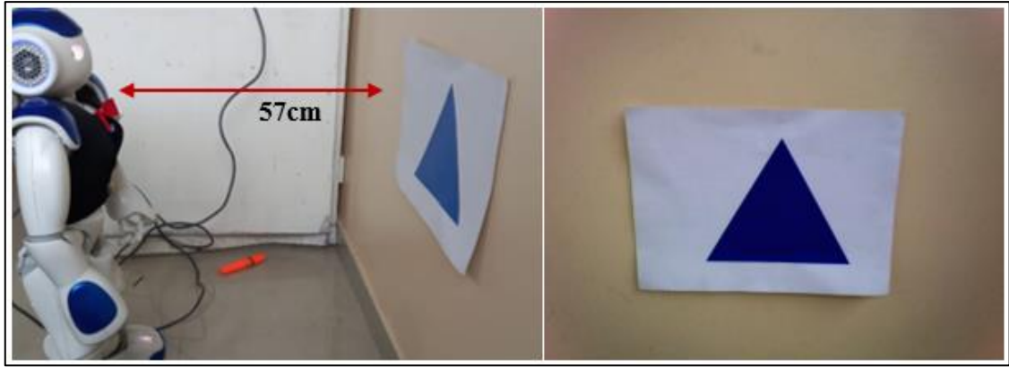
Figura 16-2: Imagen capturada por el robot Nao con una resolución de 320*240px a 30fps
