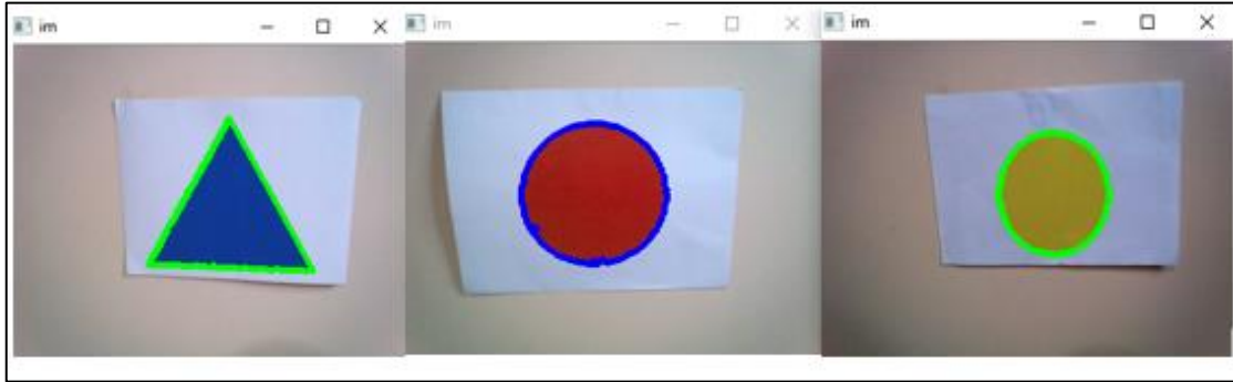
Figura 22-2: Detección de los bordes a las figuras geométricas, con la cámara de Nao
