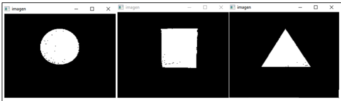
Figura 21-2: Binarización de las figuras geométricas a través de la cámara del robot Nao
