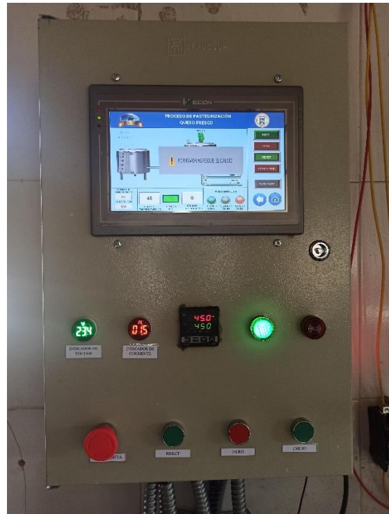
Tercer aviso para agregar calcio (45°C)
