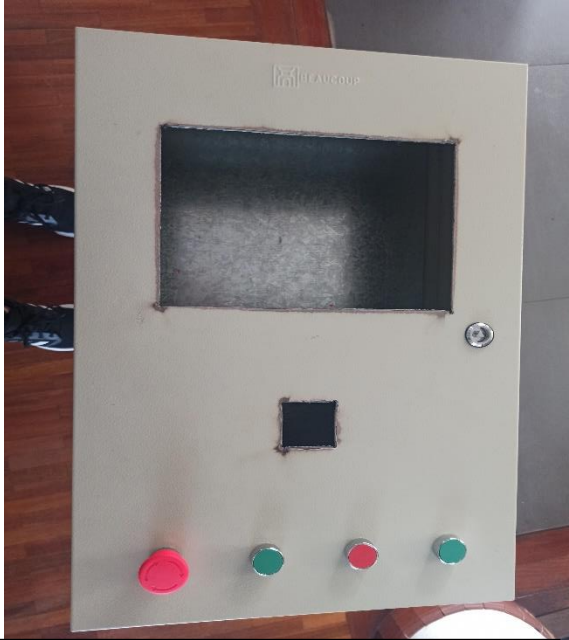
Cortes en el tablero de control para el HMI y controlador de temperatura
