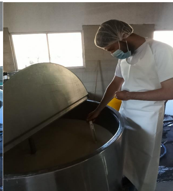
Toma de temperatura con el termómetro de leche para comparar con la temperatura del sensor de temperatura PT100
