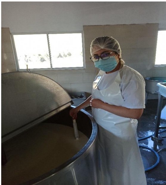
Toma de temperatura con el termómetro de leche para comparar con la temperatura del sensor de temperatura PT100
