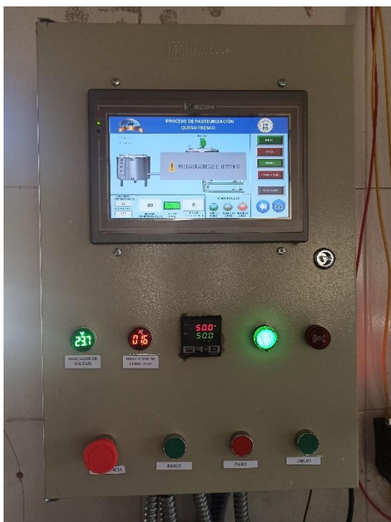
Tercer aviso para agregar fermento (50°C)
