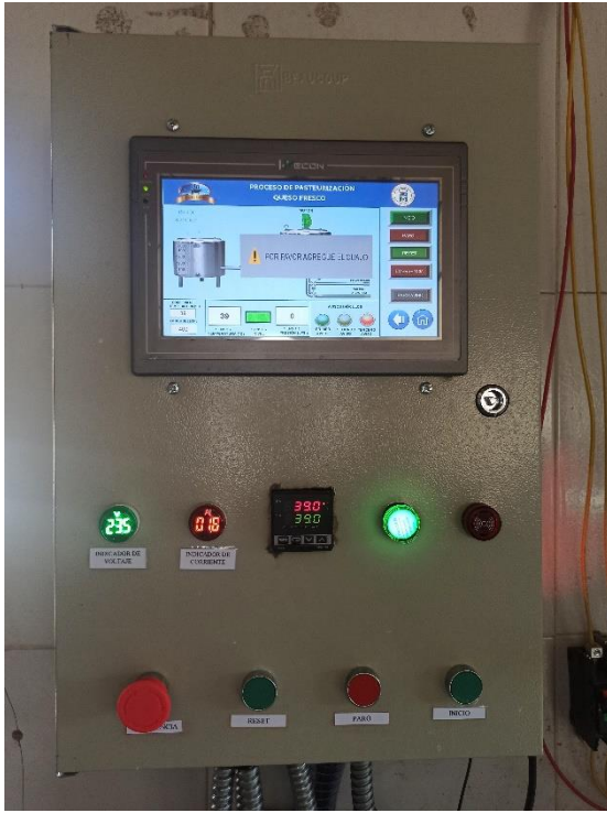
Tercer aviso para agregar cuajo (39°C)
