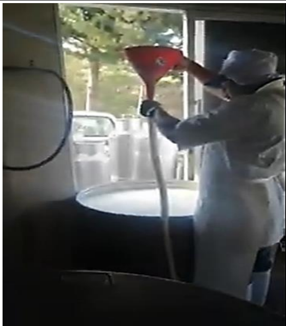
Cebado de la bomba "Pedrollo" para el paso de la leche cruda desde la olla de recepción a la olla de pasteurización.
