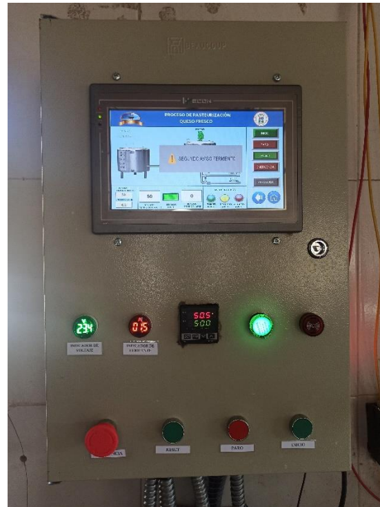
Segundo aviso para agregar fermento (50,5°C)
