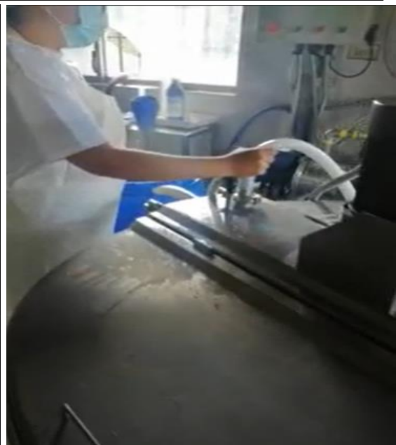
Ingreso de la leche cruda a la olla de pasteurización con la bomba de acero inoxidable de grado alimenticio
