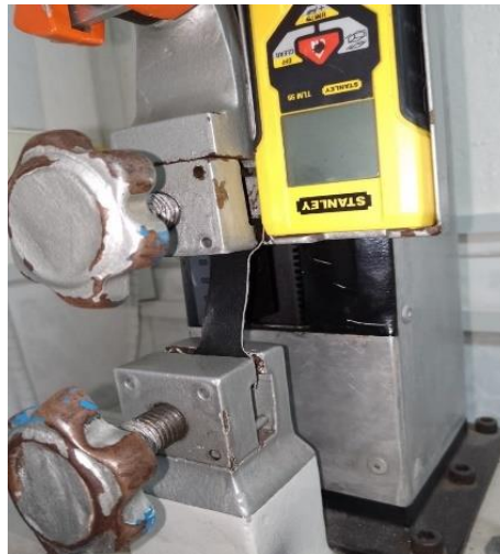
Ilustración 3-2: Máquina de medición y tensión del cuero.
