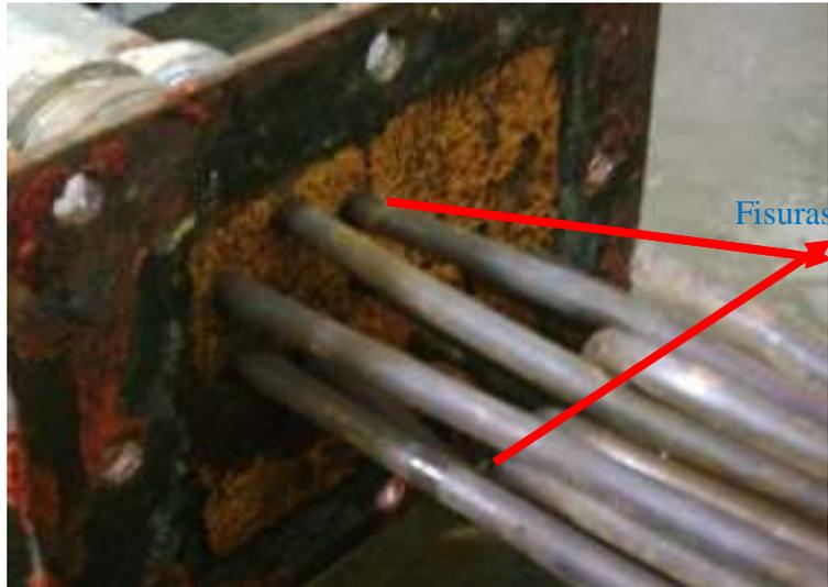
FIGURA 35. Fisuras de los serpentines actuales
