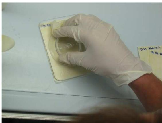
**FOTOGRAFÍA 27. DISTRIBUCIÓN DEL INÓCULO EN EL ÁREA DE CRECIMIENTO DE LA PLACA PETRIFILM.**
