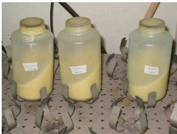
**FOTOGRAFÍA 13.** AGITACIÓN DE SOLUCIONES ALCALOIDALES DE CHOCHO
