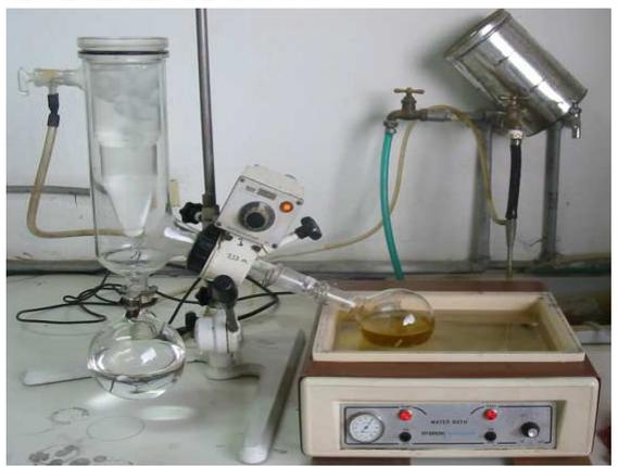
**FOTOGRAFÍA 15.** CONCENTRACIÓN DE EXTRACTOS ALCALOIDALES DE CHOCHO.
